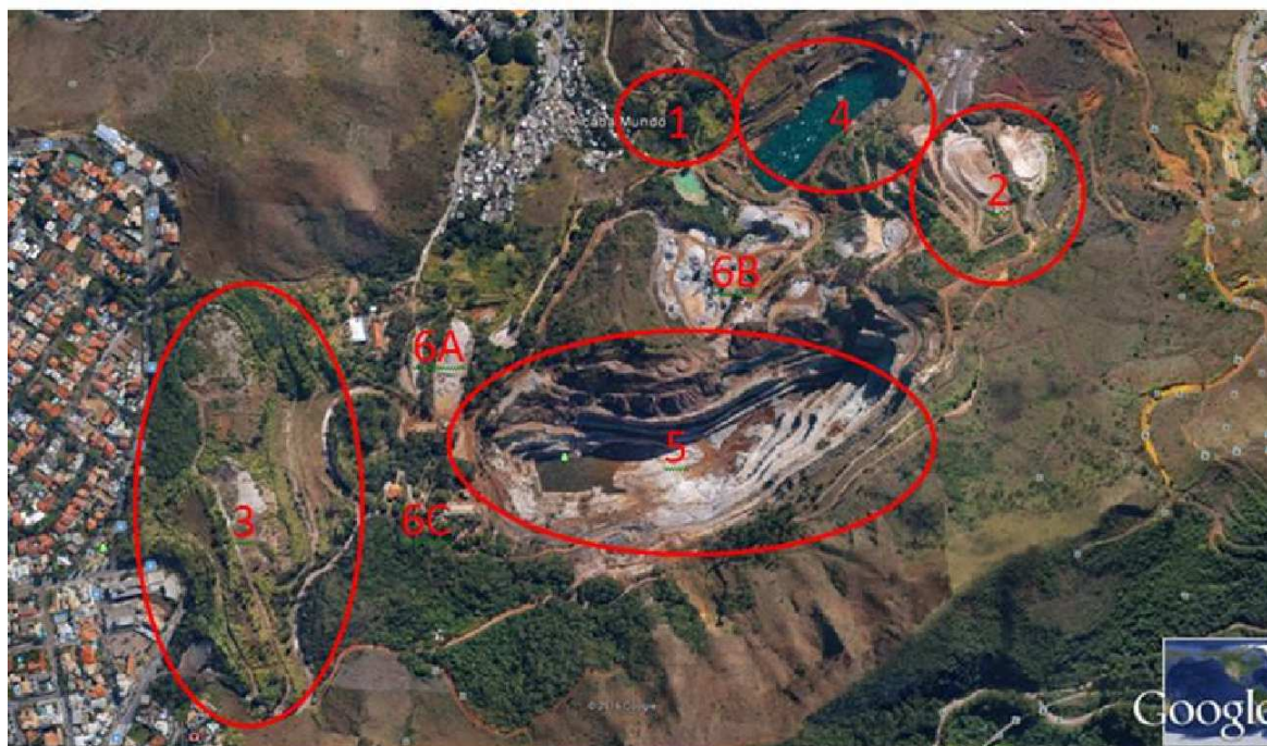
Figura 5: 1) Pilha de Estéril A; 2) Pilha de Estéril B; 3) Pilha de Estéril C; 4) Cava Mangabeiras; 5) Cava Acaba Mundo; 6) Áreas Difusas: a. Balança; b. Planta; c. Escritório
