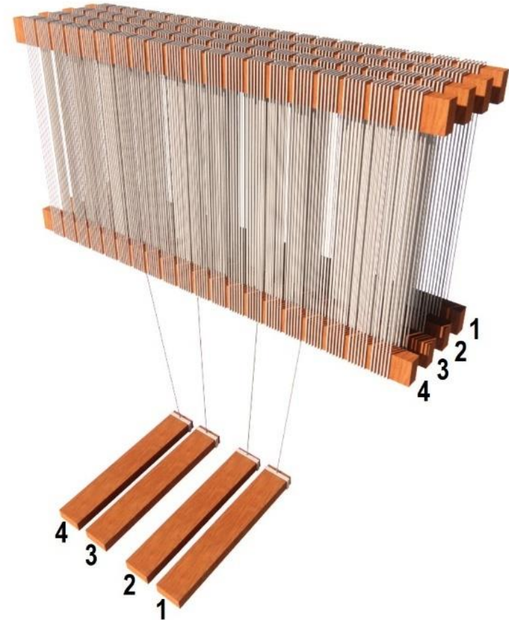
FIGURA 73 – Desenhos esquemáticos representando a amarração dos pedais nas folhas do liço
