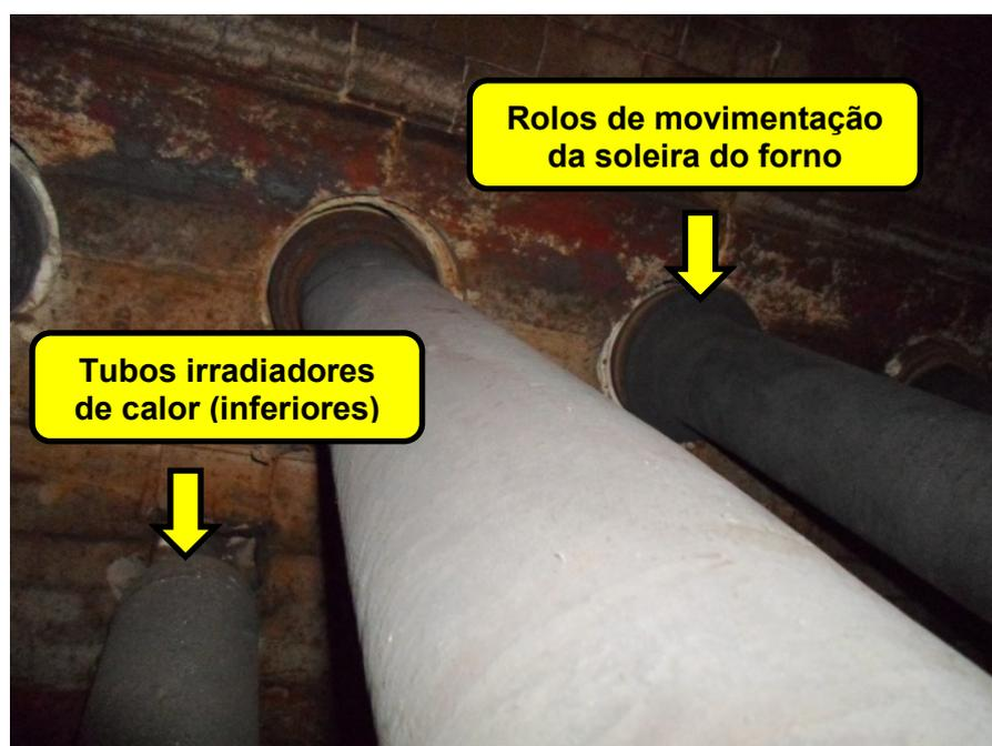
**Figura 5.6:** Região no interior do forno ilustrando os rolos da soleira e tubos irradiadores de calor inferiores.
