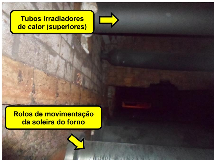
**Figura 5.5:** Região no interior do forno ilustrando os rolos da soleira e tubos irradiadores de calor superiores.
