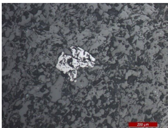
Fotomicrografia 4 – Cristal de magnetita pontual na matriz da rocha. Luz refletida – nicóis descruzados (100X)
