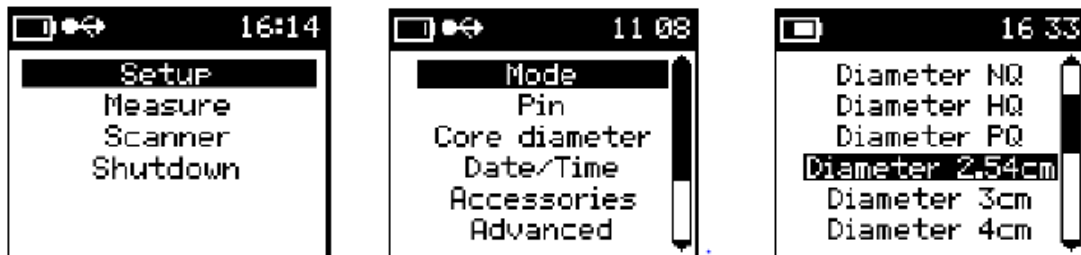
Fig. 2: Passo a passo de como configurar o KT-10 para o diâmetro do furo de sondagem a ser amostrado. Fonte: Manual do usuário KT-10.
