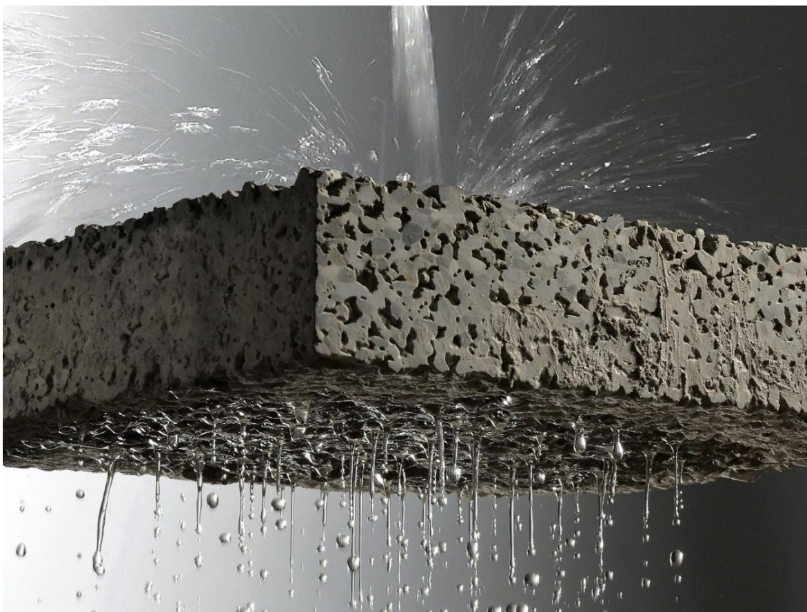
Figura 10 – Infiltração da água no piso permeável de concreto drenante
