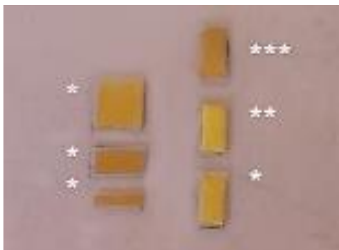
FIGURA 3.12 - Posicionamento das amostras de PVDF/Bi 2 O 3 para obtenção das imagens de TC.
