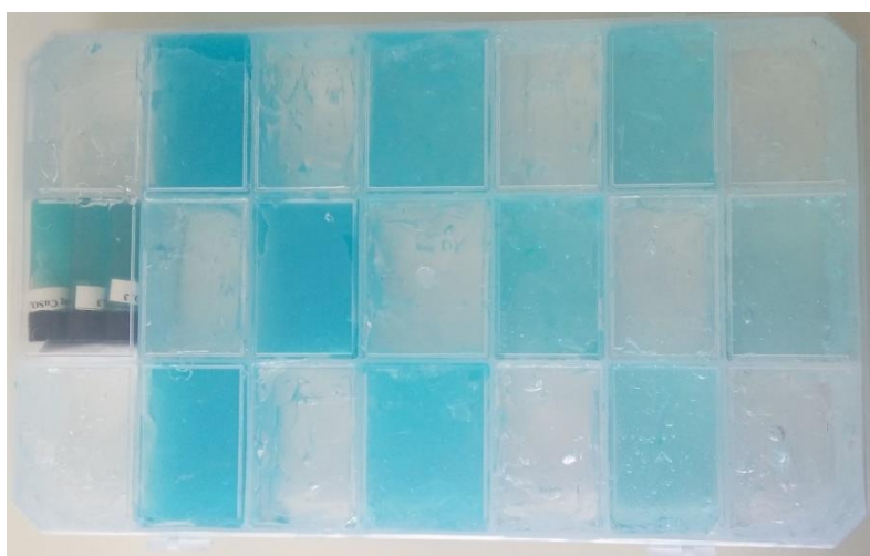
FIGURA 2.6 – Esquema utilizado por CARDOSO et al. como simulador de corpo para exames de Ressonância Magnética.
