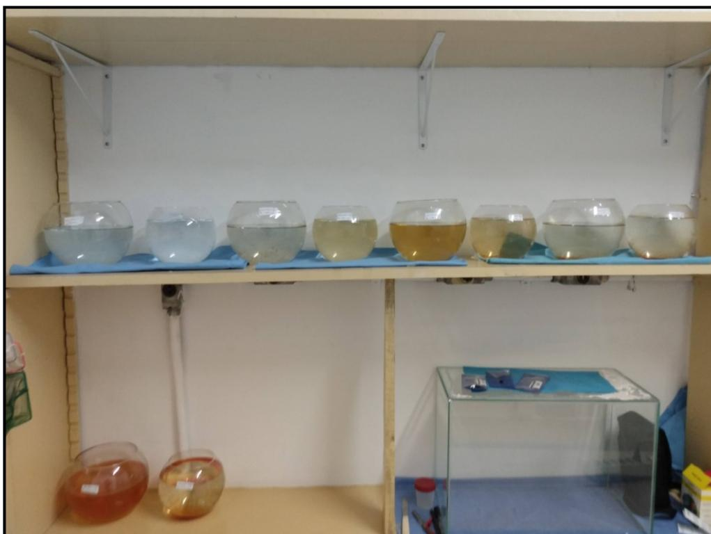
**Figura 2.** Local e aquários do ensaio de toxicidade aguda de ferro. Soluções de ferro após aeradas e dispostas no local de experimentação, antes do ensaio experimental.
