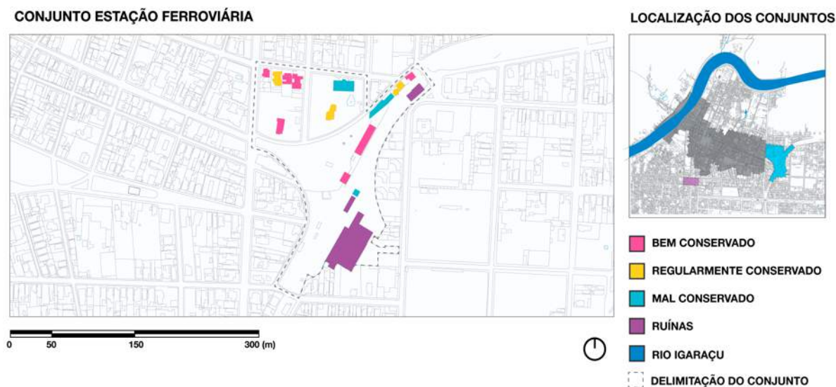
Figura 171- Estado de conservação do Conjunto Estação Ferroviária em 2020
