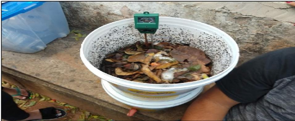
Figura 17 - Medição da umidade e pH da composteira com minhocas
