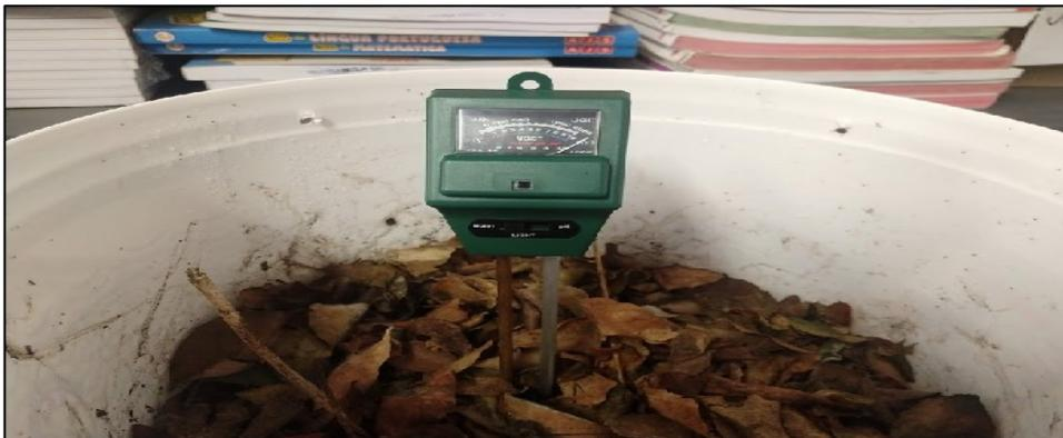
Figura 16 - Medição da umidade e pH da composteira sem minhocas
