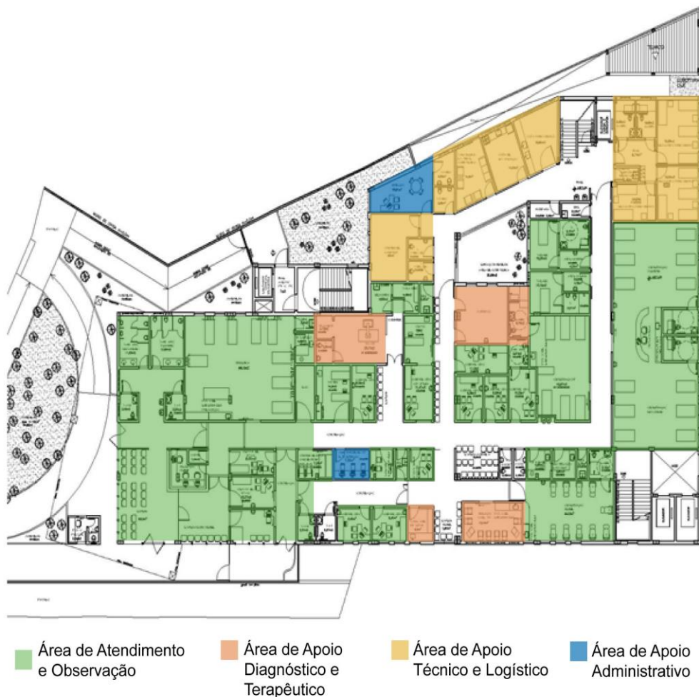
Figura 1: As quatro áreas que compõem a estrutura física da UPA em estudo
