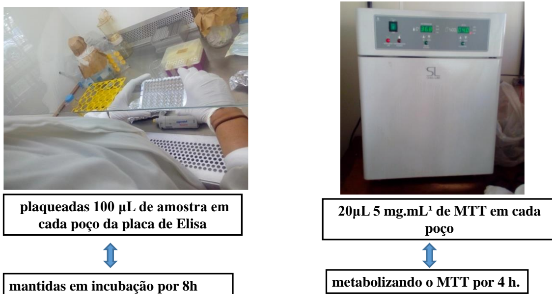
Figura 3.4 – A figura mostra a seqüência básica de procedimentos para realização do ensaio de metabolização do sal tetrazólio (MTT).
