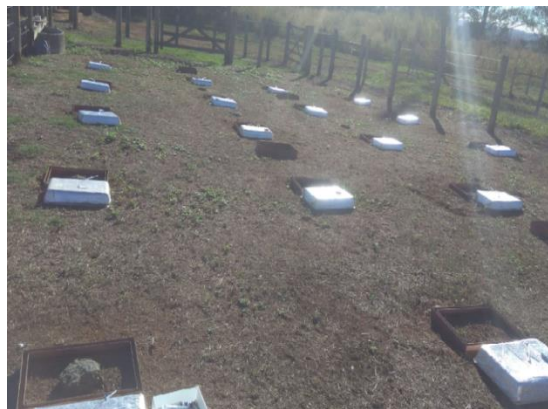
Figura 5 – Câmaras estáticas abertas na área experimental, abertas com os tratamentos (fezes e urina).
