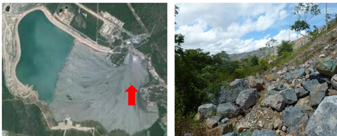
Figura 3 – Rejeitos da Mina de Sossego - Carajás PA. A) Barragem de rejeitos do processo de flotação, rejeito gerado após o beneficiamento do minério. B) Pilhas de minérios descartados pela operação de lavra antes do beneficiamento.
