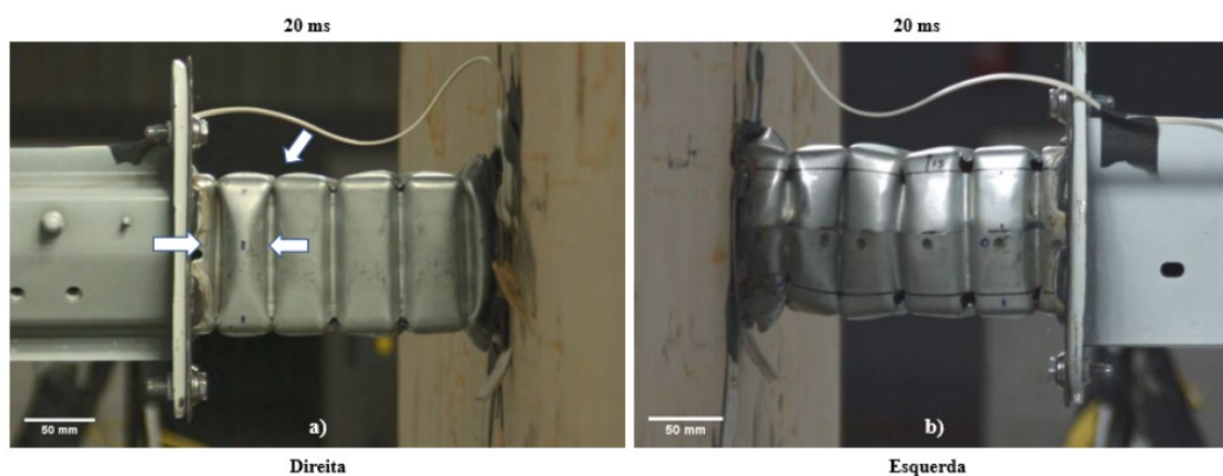
Figura 4.20 – Compactação do crash-box aos 20 ms. a) lado direito e b) lado esquerdo
