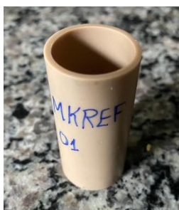
Figura 4.2.4 – Fôrma de PVC sem corte utilizada na moldagem dos corpos de prova de geopolímeros.
