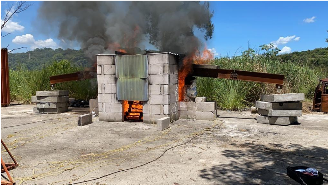
Figura 3-23 - Viga mista após o colapso, durante o ensaio.
