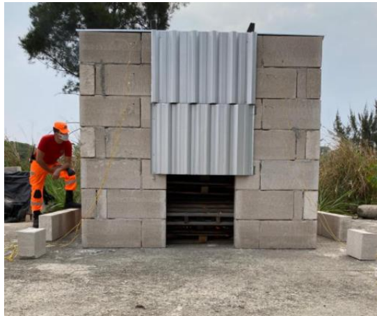
(a) Compartimento com os pallets posicionados antes da execução do primeiro ensaio
