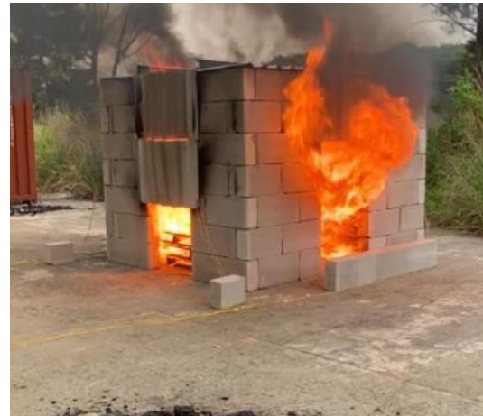
(b) Compartimento durante a execução do primeiro ensaio
