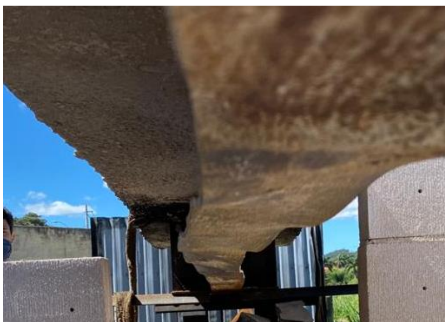
Figura 3-36 - Viga V1 após o ensaio, evidenciando flambagem lateral com distorção e flambagem local.
