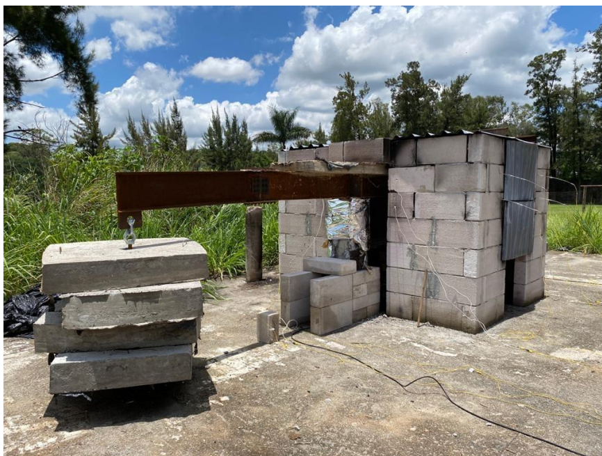
Figura 3-16 - Viga mista posicionada para ensaio com os pesos.
