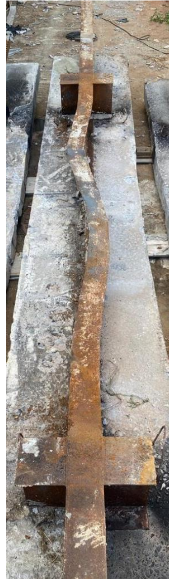
b) Vista inferior da viga após ensaio, evidenciando duas semiondas na flambagem lateral com distorção.
