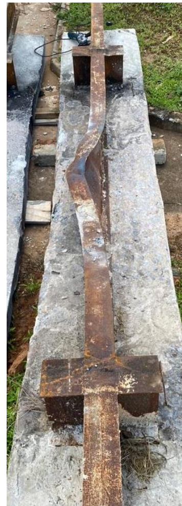
b) Vista inferior da viga após ensaio, evidenciando uma semiondas na flambagem lateral com distorção.
