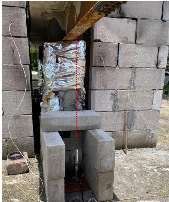
a) LVDT e cabo de aço (indicado em vermelho) para medição de deslocamento vertical.
