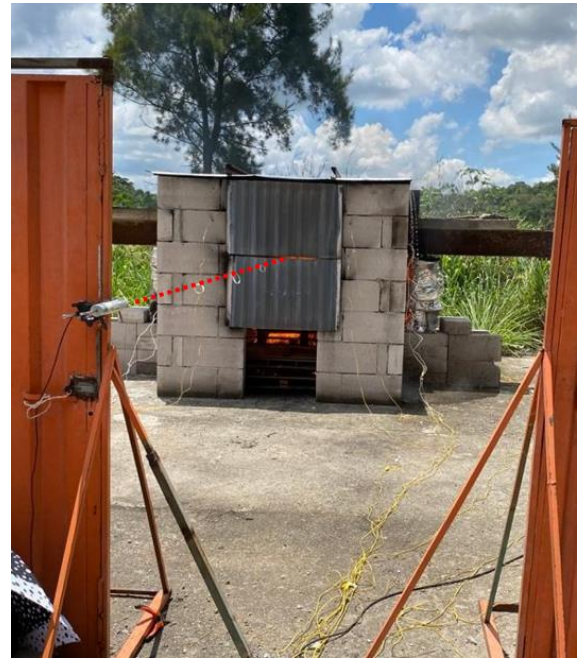
a) LVDT e cabo de aço (indicado em vermelho) para medição de deslocamento transversal.
