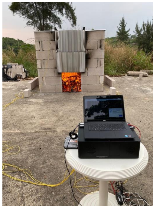
Figura 3-8 - Sistema de aquisição de dados montado durante ensaio.
