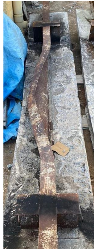
b) Vista inferior da viga após ensaio, evidenciando uma única semionda na flambagem lateral com distorção.
