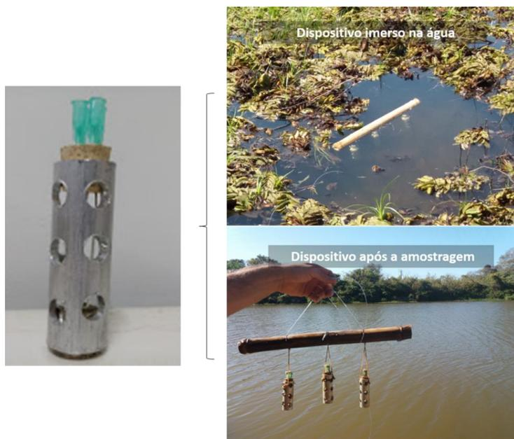
**Figura 47.** Fotografia do dispositivo modificado para amostragem passiva de agrotóxicos baseado no sistema HF-LPME.
