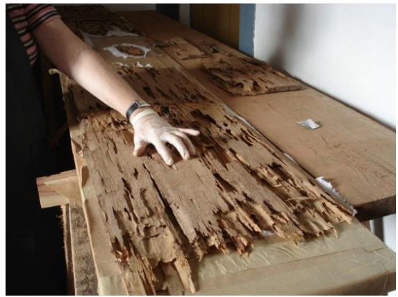
FIGURAS 121,122: Tábuas de teto da Casa Padre Toledo com a presença de insetos xilófagos e os danos que causaram. Fotografia do autor, 2010.
