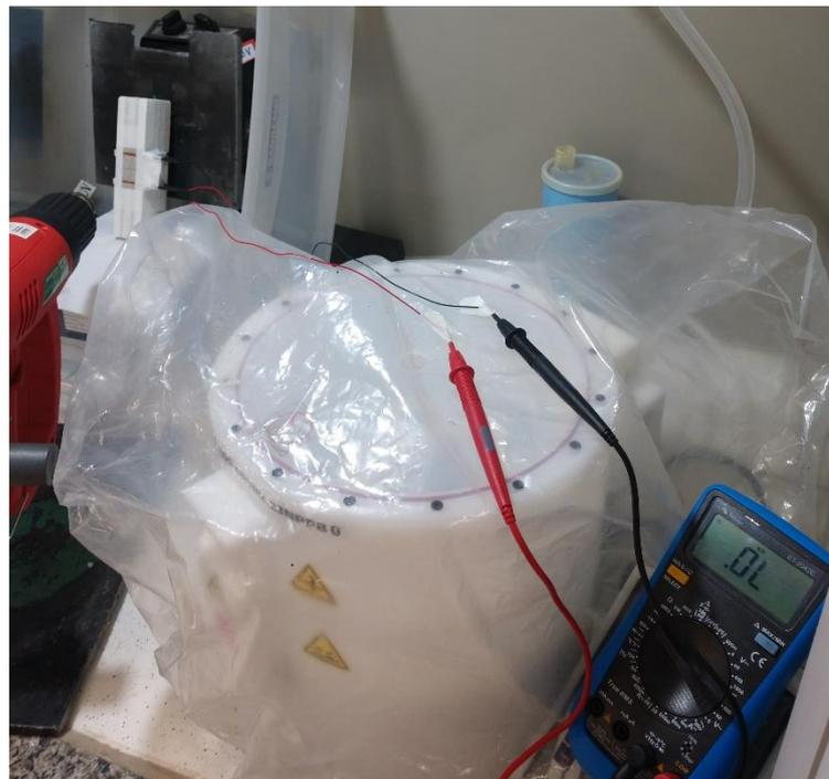
Figura 4.14: Monitoramento da resistência elétrica do sensor através da leitura em um multímetro.
