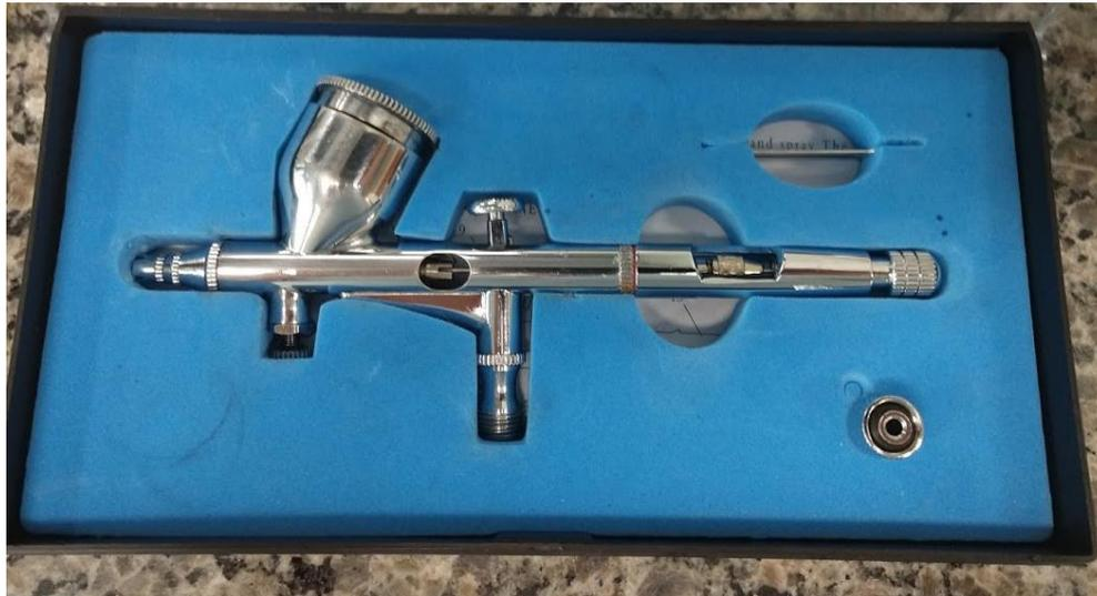
Figura 4.12: Aerógrafo para a aplicação da tinta piezo-resistiva.
