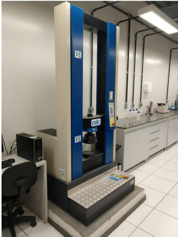
Figura 4.22: Máquina universal para aplicação de esforço de compressão no corpo de prova.
