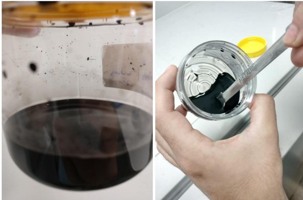
Figura 4.6: Consistência da tinta piezo-resistiva.
