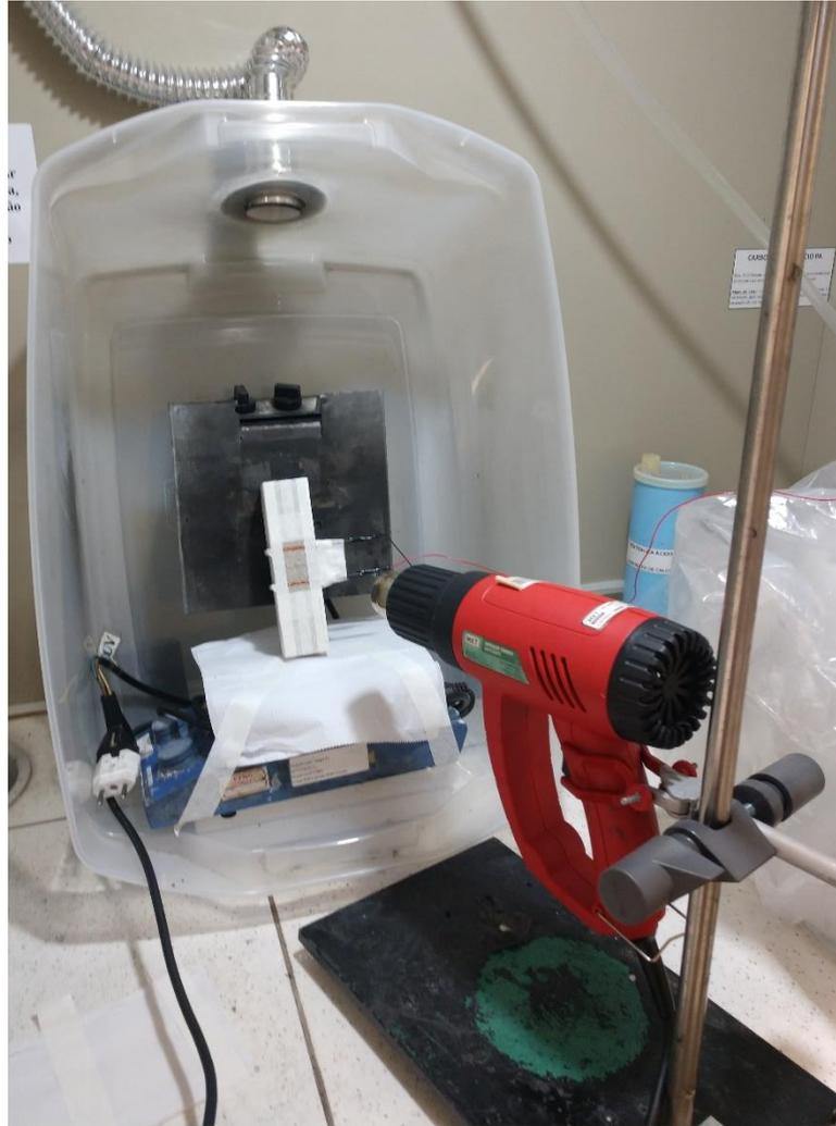
Figura 4.13: Aquecimento da superfície do corpo de prova através de um soprador industrial.
