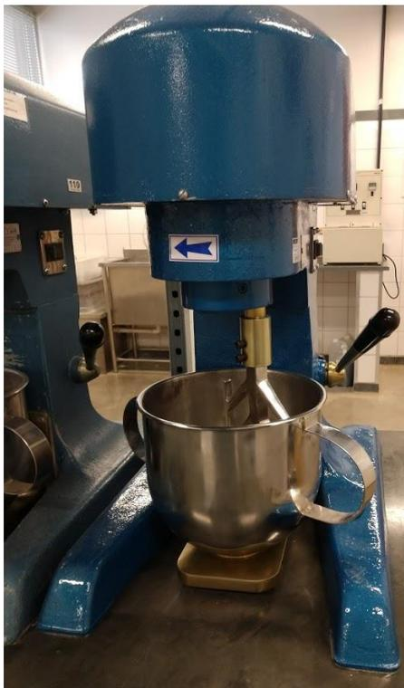
Figura 4.3: Cuba de aço utilizada na produção de argamassa.
