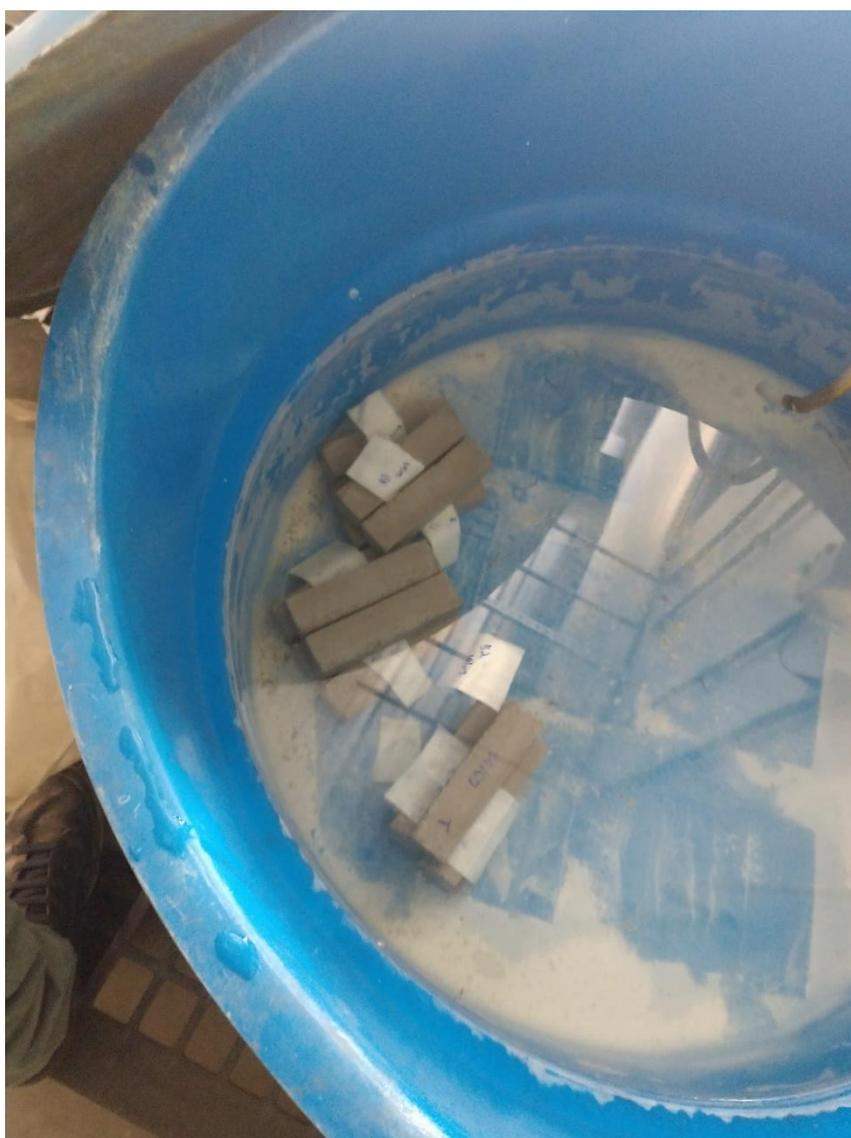
Figura 4.4: Corpos de prova em processo de cura.
