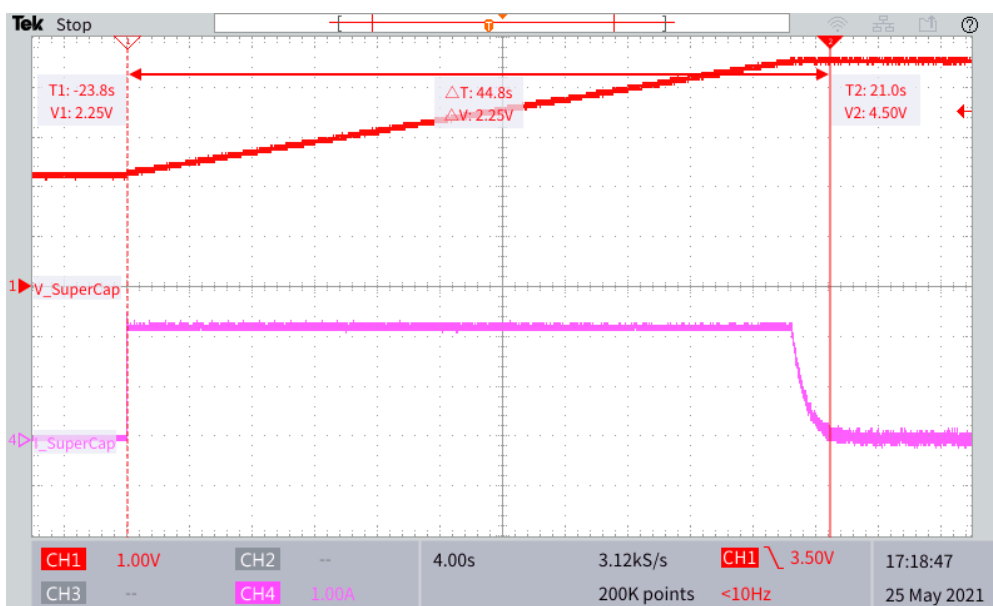
Figura 65 – Tensão (CH1) e corrente no supercapacitor (CH4) durante todo o período de recarga.
