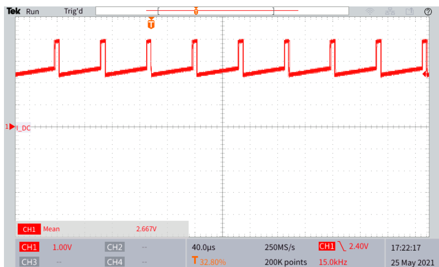
Figura 62 – Corrente de entrada do conversor c.c./c.c. (CH1) nos momentos finais da recarga do supercapacitor.
