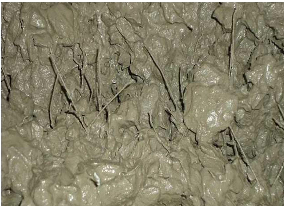
Figura 3.8 – Concreto no estado fresco com fibras sintéticas.
