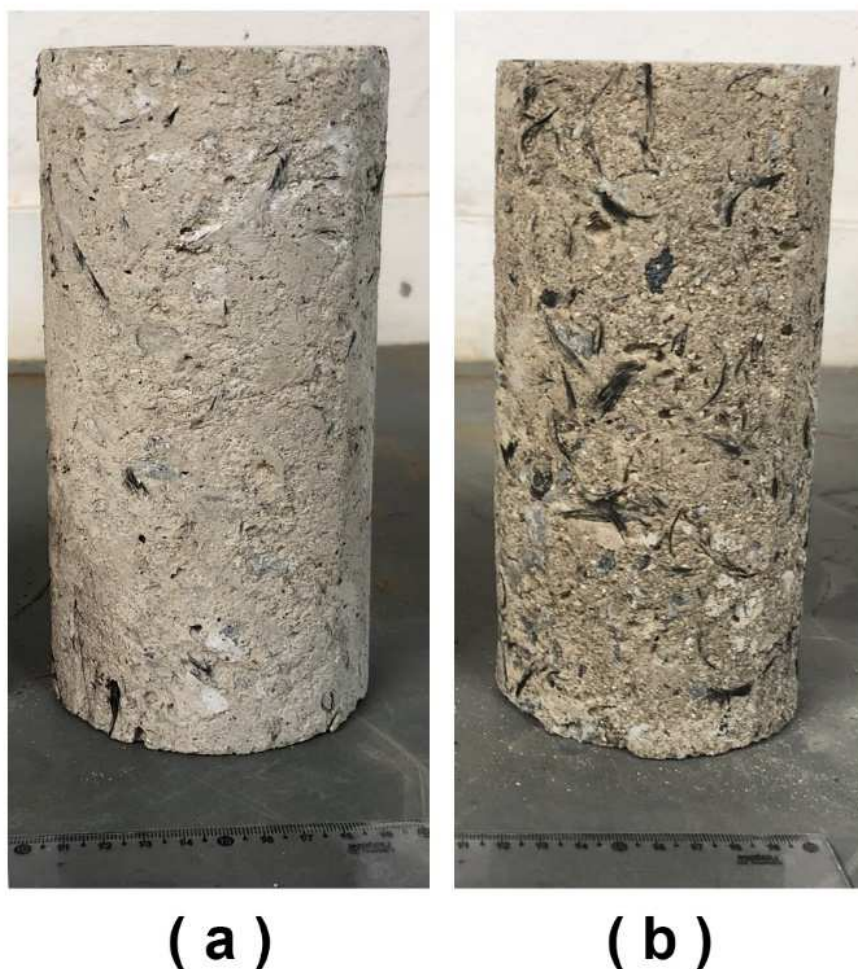
Figura 5.18 – Concreto com 2% de fibras de carbono: (a) antes do ataque; (b) depois do ataque.
