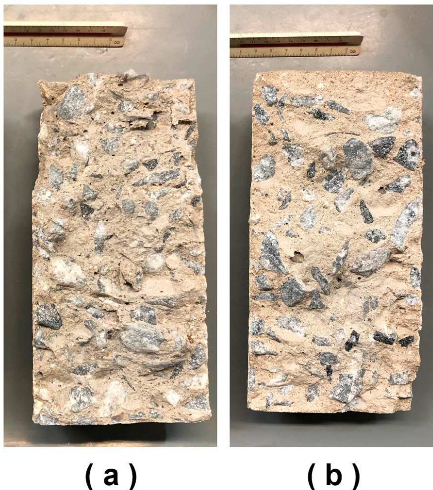
Figura 5.19 – Inspeção visual da seção do concreto: (a) 2% de fibras de carbono; (b) convencional.
