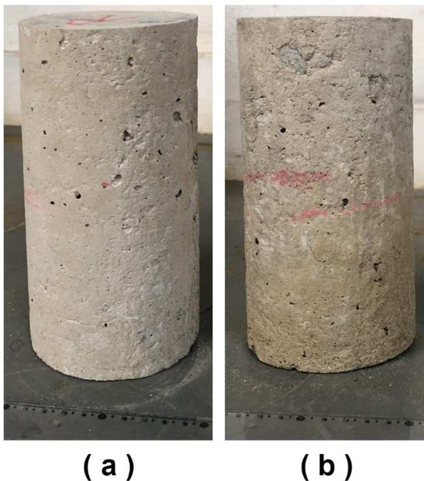
Figura 5.17 – Concreto convencional: (a) antes do ataque; (b) depois do ataque.
