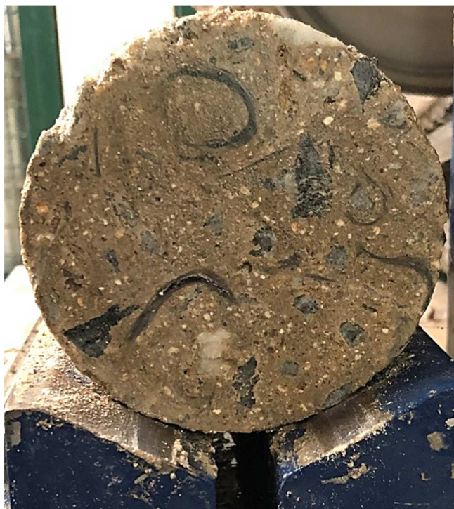
Figura 5.10 – Conjunto de fibras de carbono aglutinadas e incrustadas na superfície retificada de um corpo de prova cilíndrico.
