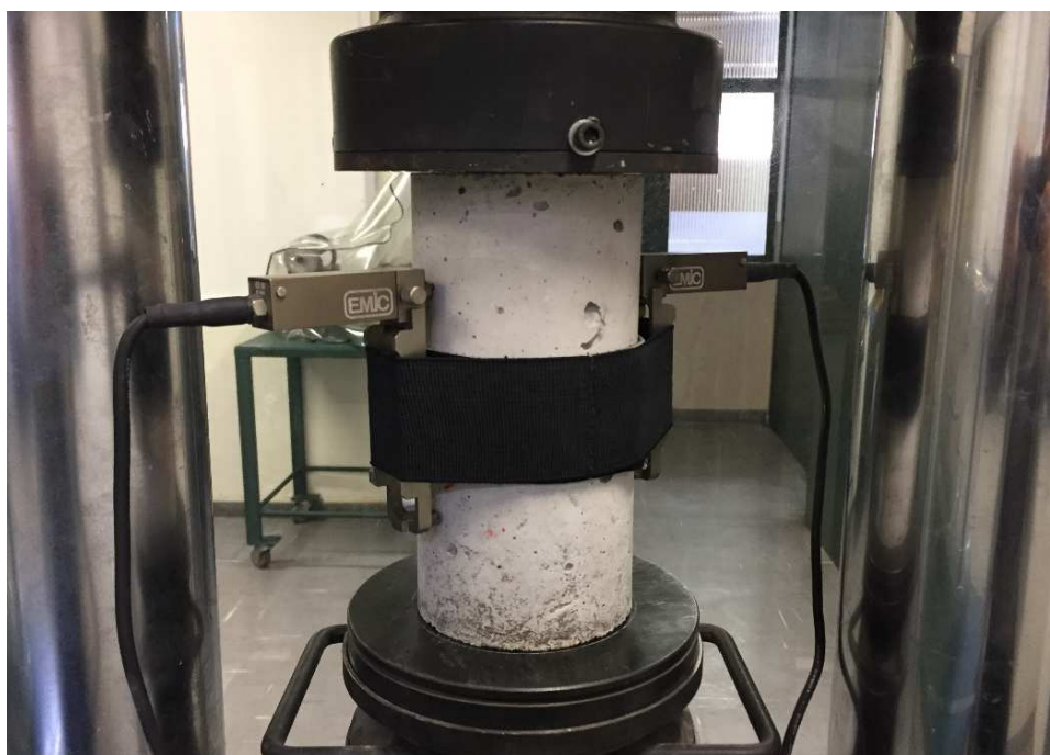
Figura 4.2 – Ensaio de módulo de elasticidade de corpo de prova cilíndrico.
