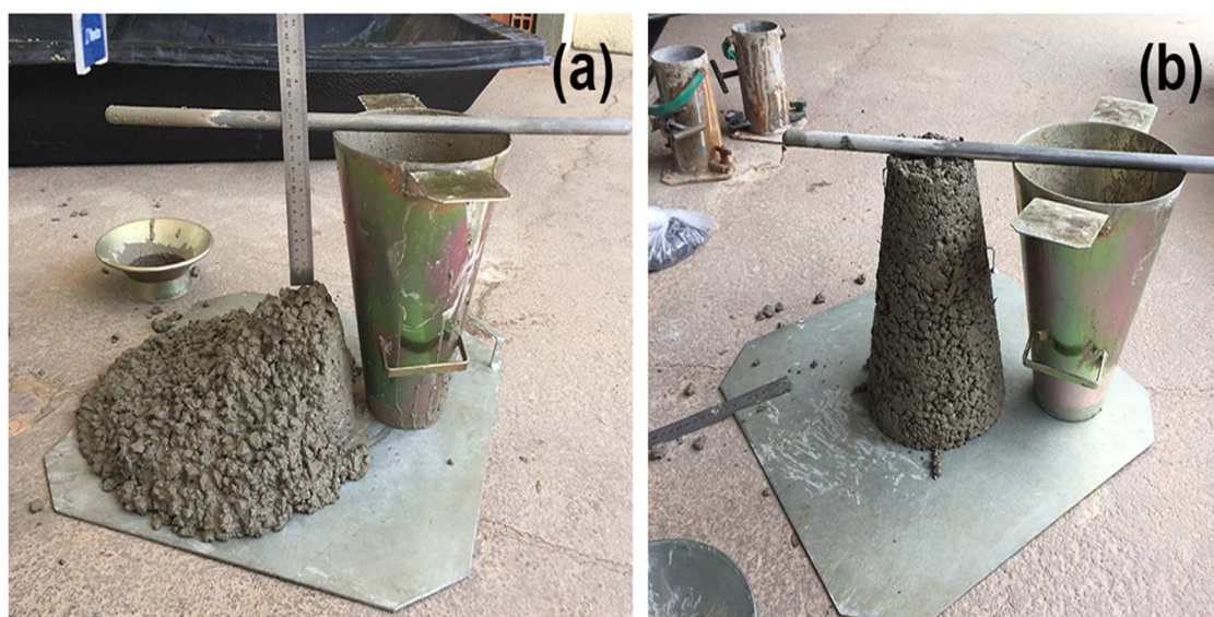
Figura 5.9– Ensaio de abatimento do tronco de cone: (a) concreto de referência; (b) concreto com fibras de carbono.
