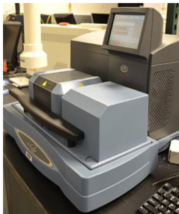
FIGURA 22- Equipamento de termogravimetria SDT TA Instrumento modelo Q600
