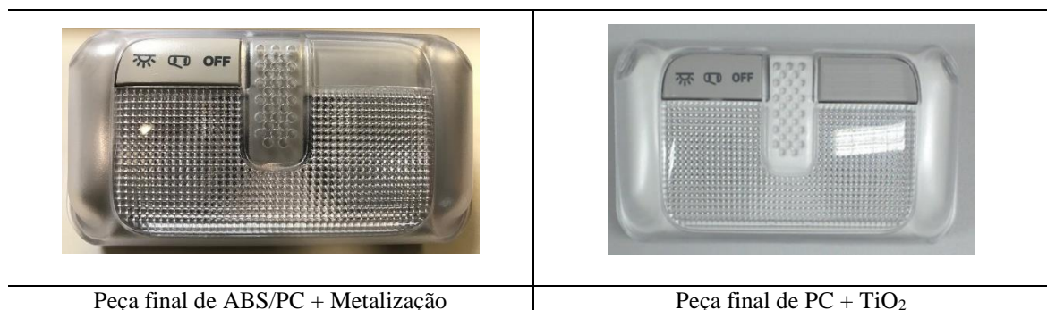
FIGURA 19- Amostra final dos refletores montados com a lente de PMMA
