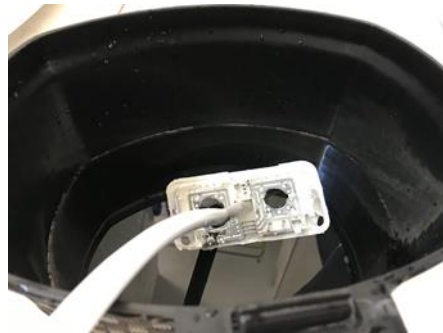
FIGURA 24- Montagem do teste de resistência da soldagem em tanque com água.
