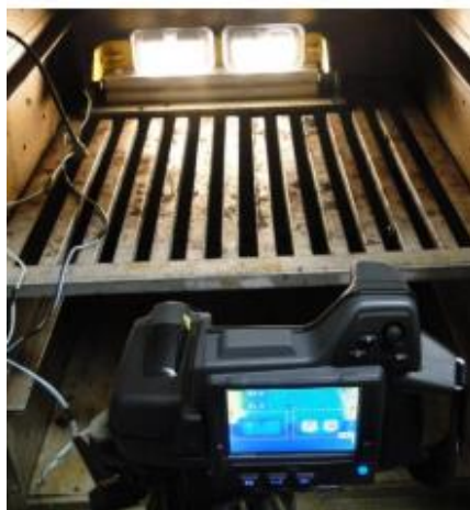
FIGURA 30- Esquema de montagem do equipamento de termografia e da câmara climática
