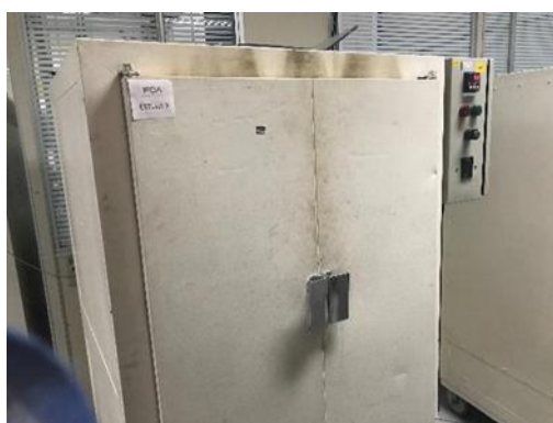
FIGURA 29- Câmara climática onde foi realizado o teste a 60°C \pm 2^{\circ}\text{C}
