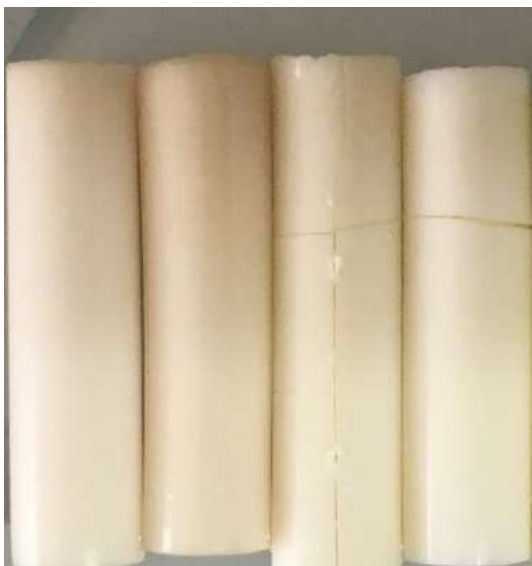
Figura 38: Xerogéis de compósito 3PEGSiNb após imersão em água, em solução de amônia pH 10 (24 h), em solução de amônia pH 12 (24 e 48 h) e em solução de amônia pH 12 (da esquerda para a direita).
