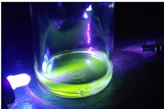
Figura 4.4: Luminescência do  $Tb(H_3PTC)_3$  em solução quando excitado por um laser ultravioleta com comprimento de onda 454nm.
