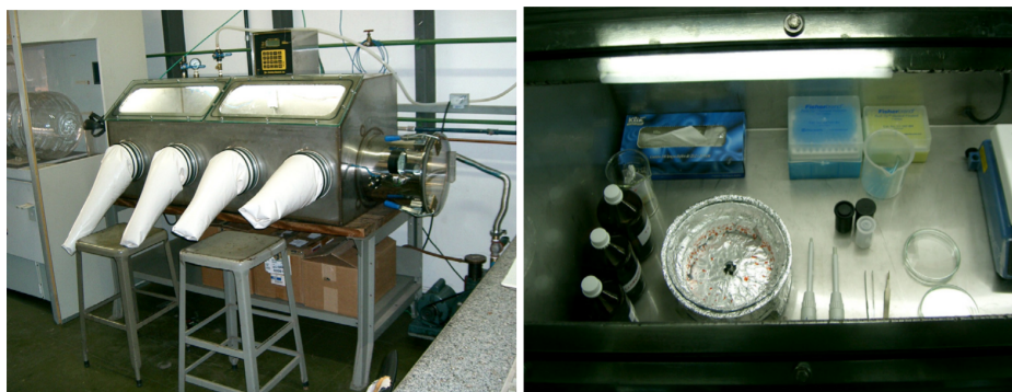
Figura 10 – Foto ilustrando a câmara-seca e seu interior onde os filmes dropcast de blendas de Sonda:Zeonex com baixas concentrações foram produzidos.
