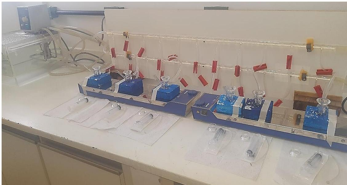
Figura 4.4 – Esquema do experimento de permeação cutânea. Próprio autor.
