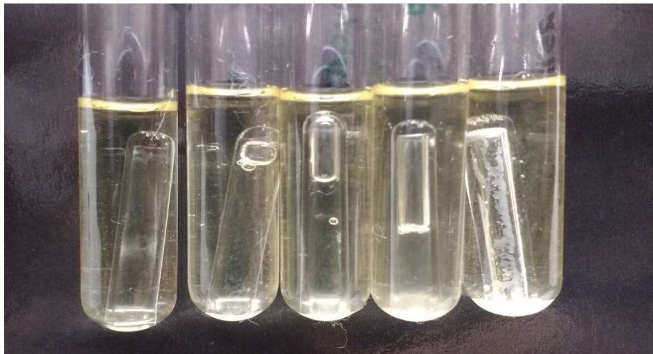
Figura 8 – Ilustração da fermentação da maltose pelas linhagens de S. cerevisiae em tubos de ensaio e tubo de Durham. Na imagem é possível notar o preenchimento do tubo de Durham com gás carbônico, identificando o processo fermentativo.
