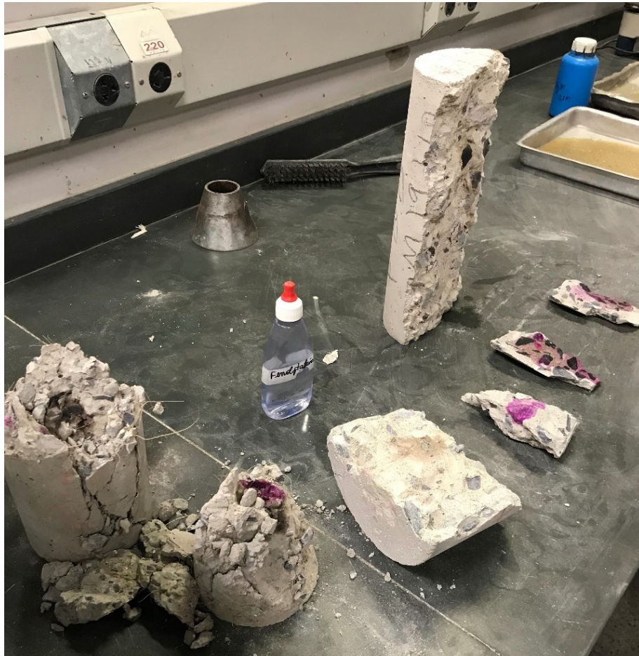
Fotografia 1: Corpos de prova com uso de fenolftaleína
