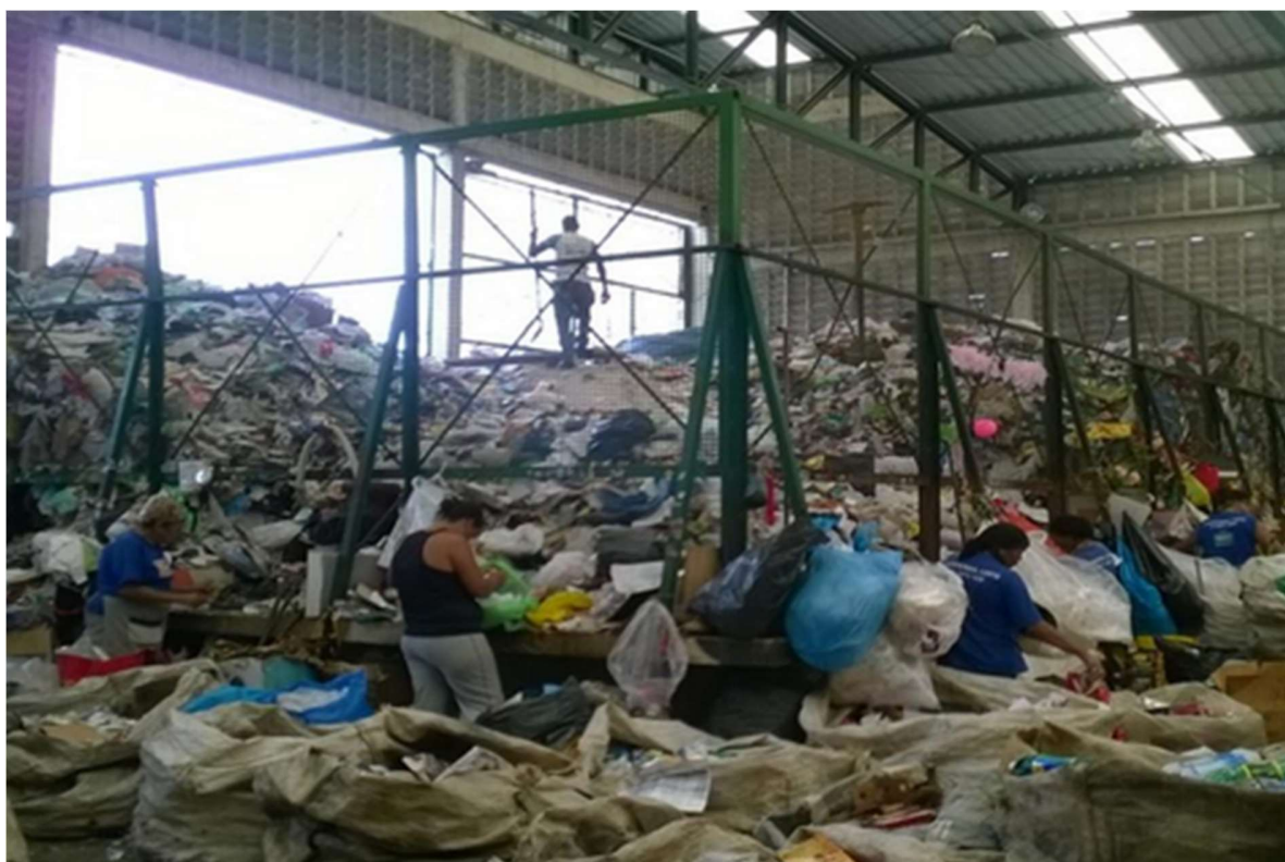
Figura 14 - Fotografia do silo e das janelas/bancadas de triagem
