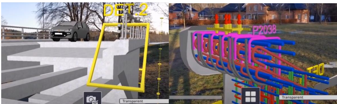
Figura 30: Visualização de um detalhe construtivo no Trimble Site Vision. Fonte: (NEVES, 2020).
