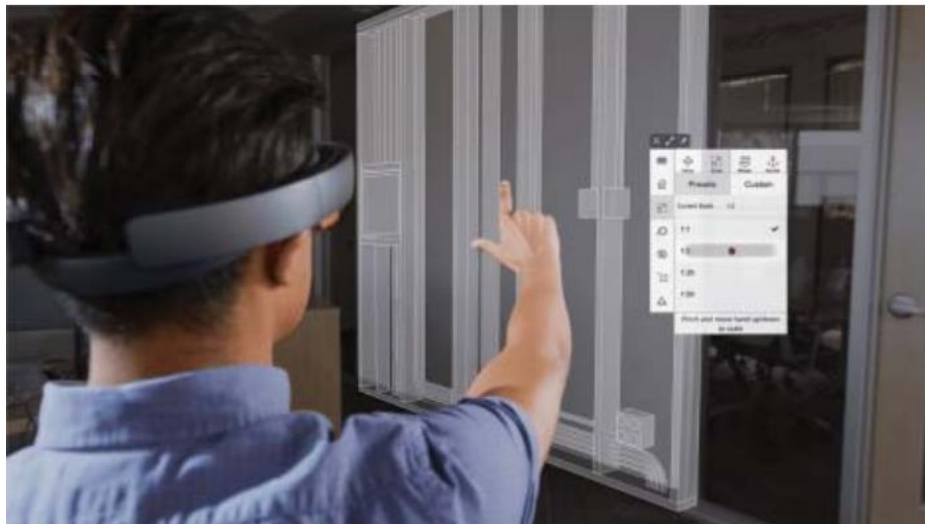
Figura 18: Óculos de realidade aumentada sobrepondo um painel drywall no ambiente real. Fonte:(EASTMAN et al., 2018).
