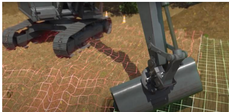
Figura 22: Máquina conduzida semi-automática para cortes e taludes. Fonte:(GRANADEIRO, 2021).
