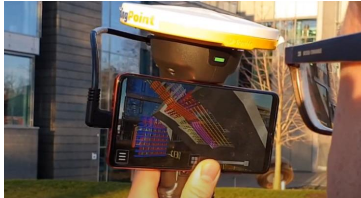
Figura 29: Dispositivo para visualização do modelo BIM em campo – Trimble Site Vision.
