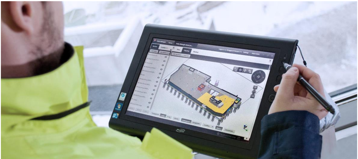
Figura 15: Dispositivo móvel para acesso de modelos BIM. Fonte: (TEKLA, 2021).
