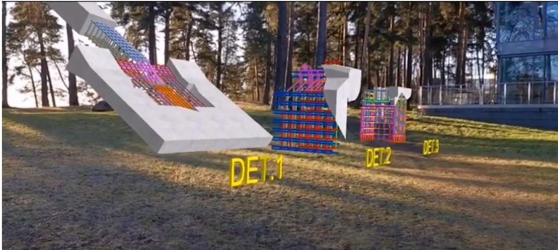
Figura 31: Visualização de três detalhes construtivos no Trimble Site Vision. Fonte: (NEVES, 2020).
