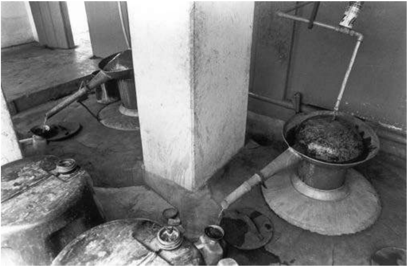
Figura 141 – Destilação do caldo fermentado em “alambiques de capelo”, município de Salinas
