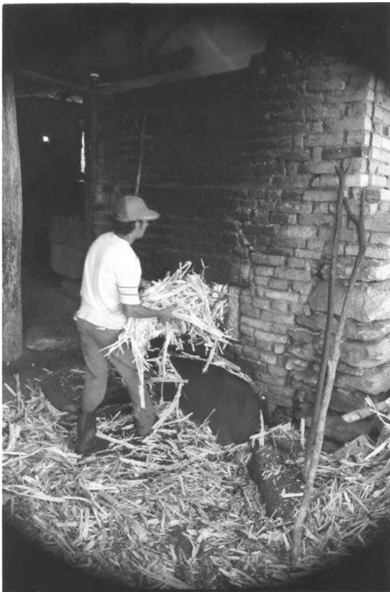
Figura 121 – Abastecimento da fornalha com bagaço de cana, município de Cambuquira
