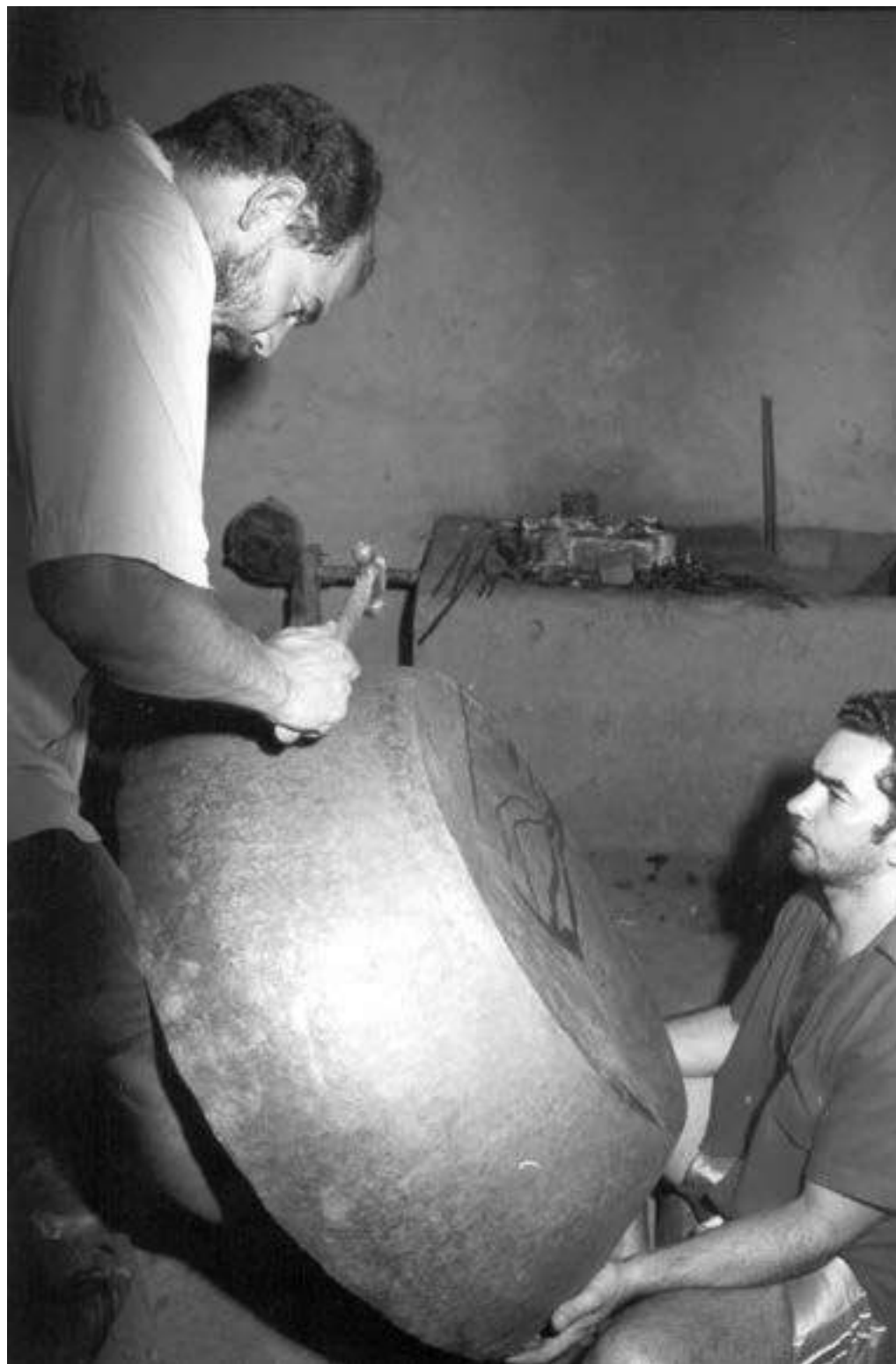
Figura 146 – Fabricação de peças e equipamentos para engenhos de cana, “batimento do cobre” e “levantamento do tacho”, município de Minas Novas
