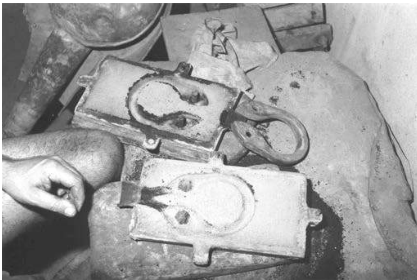
Figura 144 – Fabricação de peças e equipamentos para engenhos de cana, preparação de fôrma de alça de tacho, município de Minas Novas
