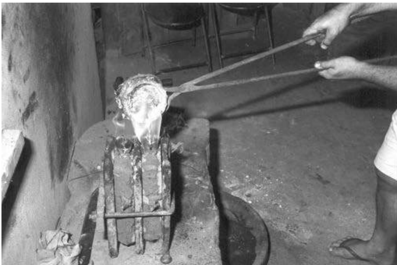
Figura 145 – Fabricação de peças e equipamentos para engenhos de cana, enchimento da fôrma com bronze fundido, município de Minas Novas
