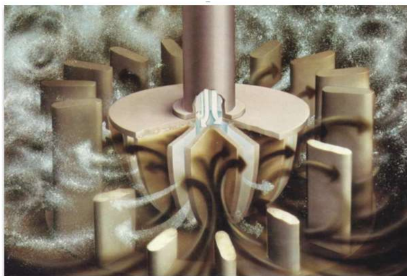
Figura 3.32 - Padrão de fluxo típico em uma Célula de Flotação mecânica.
