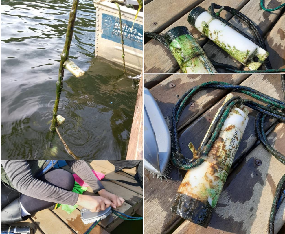
Fig. 3 - Acúmulo de biofilme em cordas e sensores. A limpeza e a manutenção deve ser periódica e regular a fim de garantir a qualidade dos dados coletados. Recomenda-se a limpeza das cordas com escova ou esponja. Os sensores devem ser limpos apenas com o auxílio de um tecido macio.
