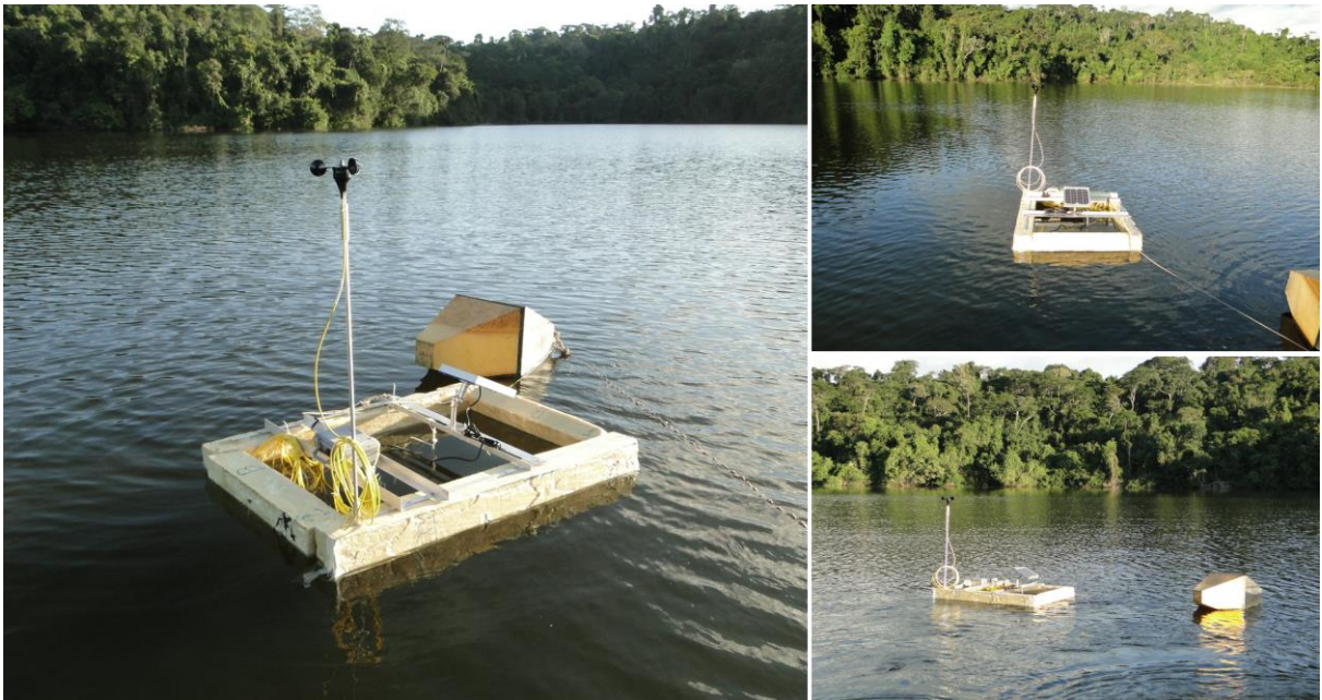
Fig. 2 - Estrutura e sensores utilizados no período de 2011 a 2013 nos lagos do PERD.
