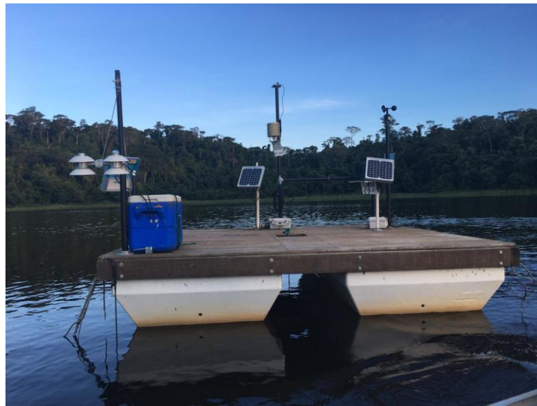
Fig. 5 - Plataforma e sensores instalados na lagoa Carioca (PERD) desde 2017.
