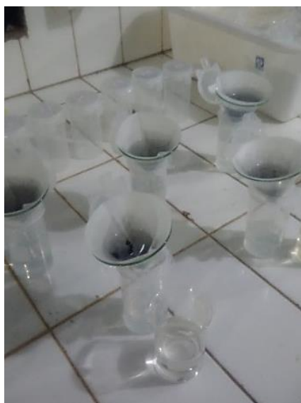
Figura 3.8 Imagem do processo de filtração utilizado durante a simulação do tratamento de água.
