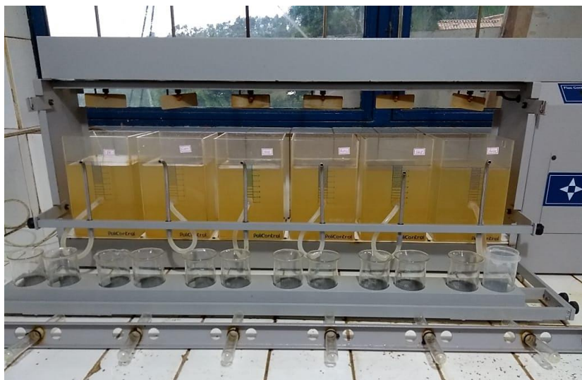
Figura 3.1 Imagem do equipamento Jar Test contendo 2,00 litros da água bruta do Rio Turvo Sujo em cada um dos seis jarros.
