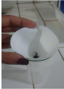
Figura 3.2 Imagem do simulador de um filtro contendo no funil um papel de filtro quantitativo e uma pequena quantidade de carvão ativado em pó.
