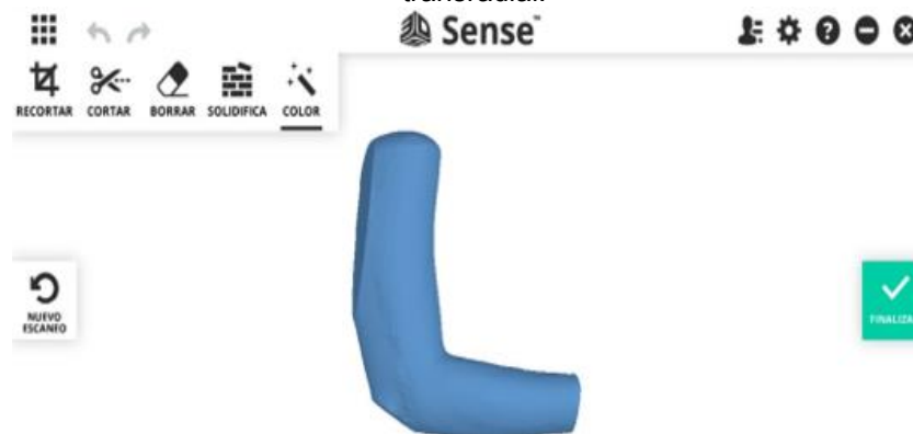
Figura 42 - Digitalização 3D do membro superior esquerdo, com corte simulando amputação transradial.
