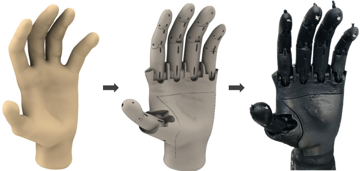
Figura 62 - Comparação da simetria e proporção de tamanho entre o membro escaneado e a prótese obtida por este processo automatizado.
