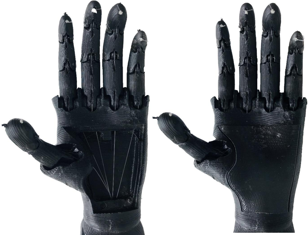
Figura 58 - Estrutura montada da mão do dispositivo.
