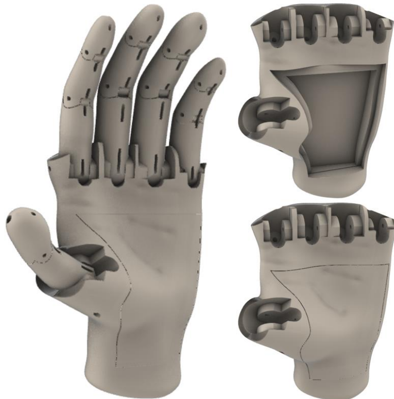
Figura 49 - Modelo final da estrutura da palma do dispositivo protético.
