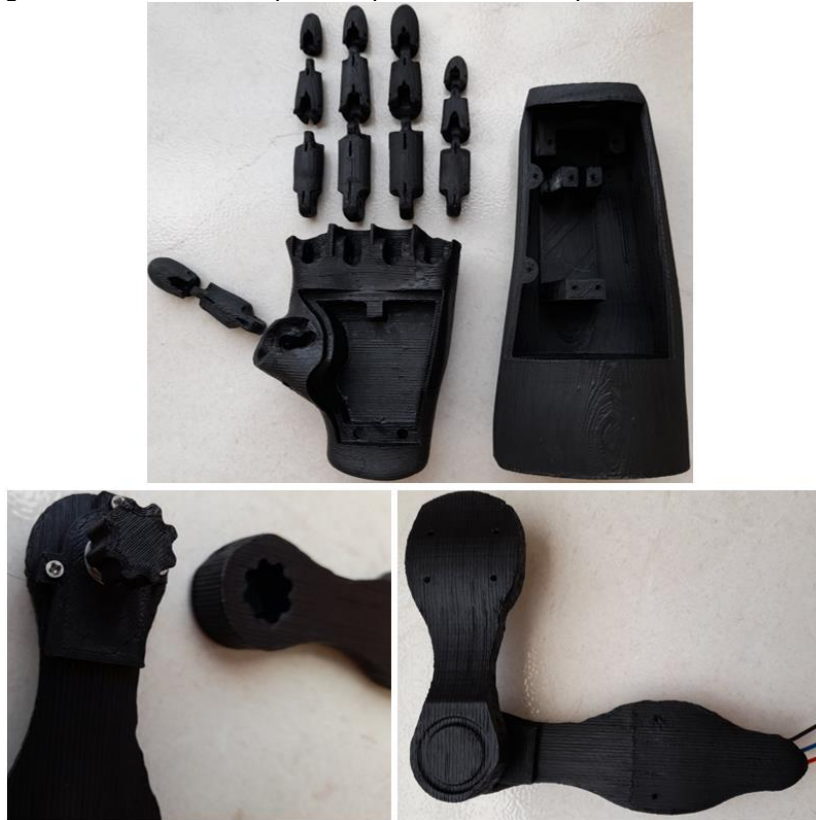
Figura 56 - Partes do dispositivo protético obtidas por manufatura aditiva.
