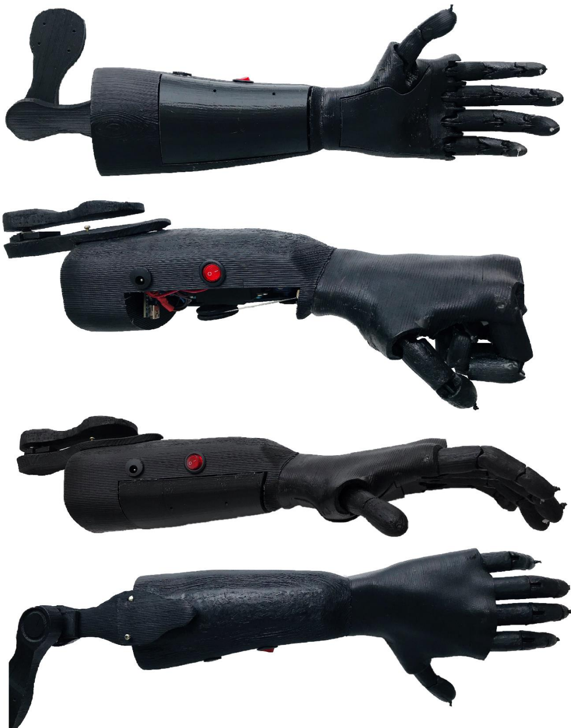
Figura 61 - Dispositivo protético para amputação transradial desenvolvido.
