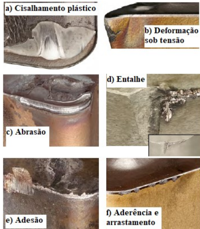
Figura 5. 3: Mecanismos de desgaste em ferramentas de corte: (a) cisalhamento plástico, (b) deformação sob tensão, (c) abrasão, (d) entalhe, (e) adesão, (f) aderência e arrastamento. Fonte: adaptado de Coromant (2017).
