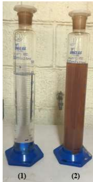
Figura 3.16 - Comparativo material filtrado. (1) Filtro cerâmico, (2) Filtro de disco a vácuo convencional (Acervo Anglo American).
