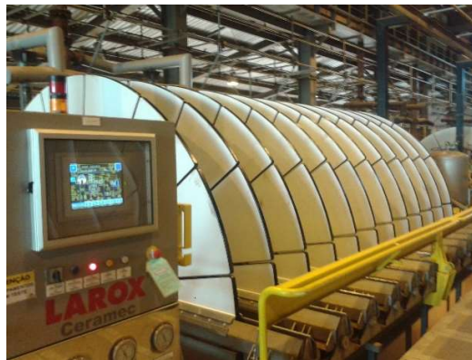
Figura 3.18 - Filtro cerâmico (Acervo Anglo American).
