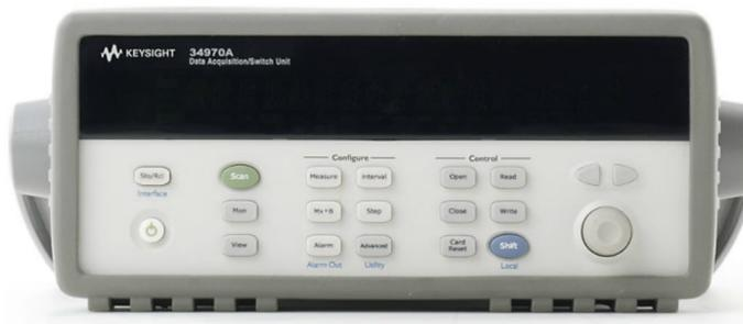
Figura 31: Sistema de aquisição de dados Agilent 34970A.
