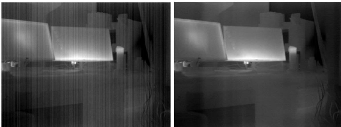
(a) Termograma com *fixed pattern noise*. (b) Termograma após a aplicação do método NUC.
