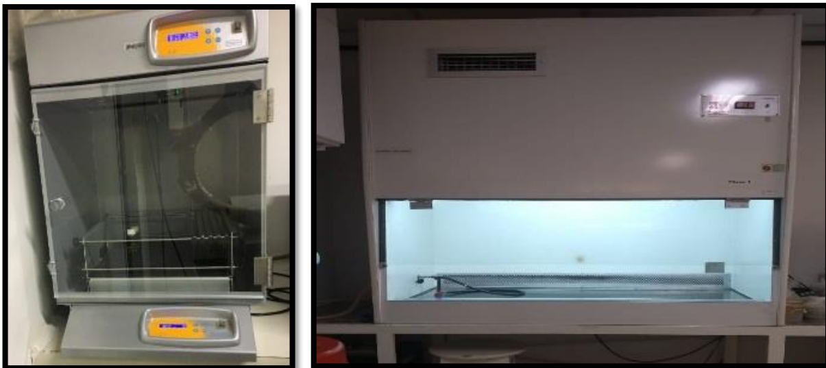
Figura 4 - A. Agitador orbital (Ovan, I10-O+ACOP.E) com controle de temperatura. B- Cabine de fluxo laminar (Veco®).
