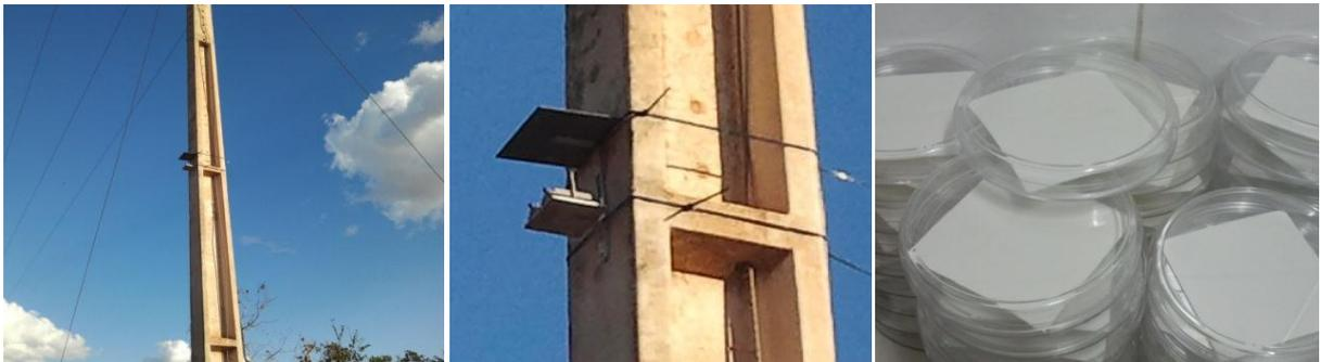
**FIGURA 13** - Amostragem de particulados em campo. Em sequência: posição em campo, coletor e películas adesivas.
