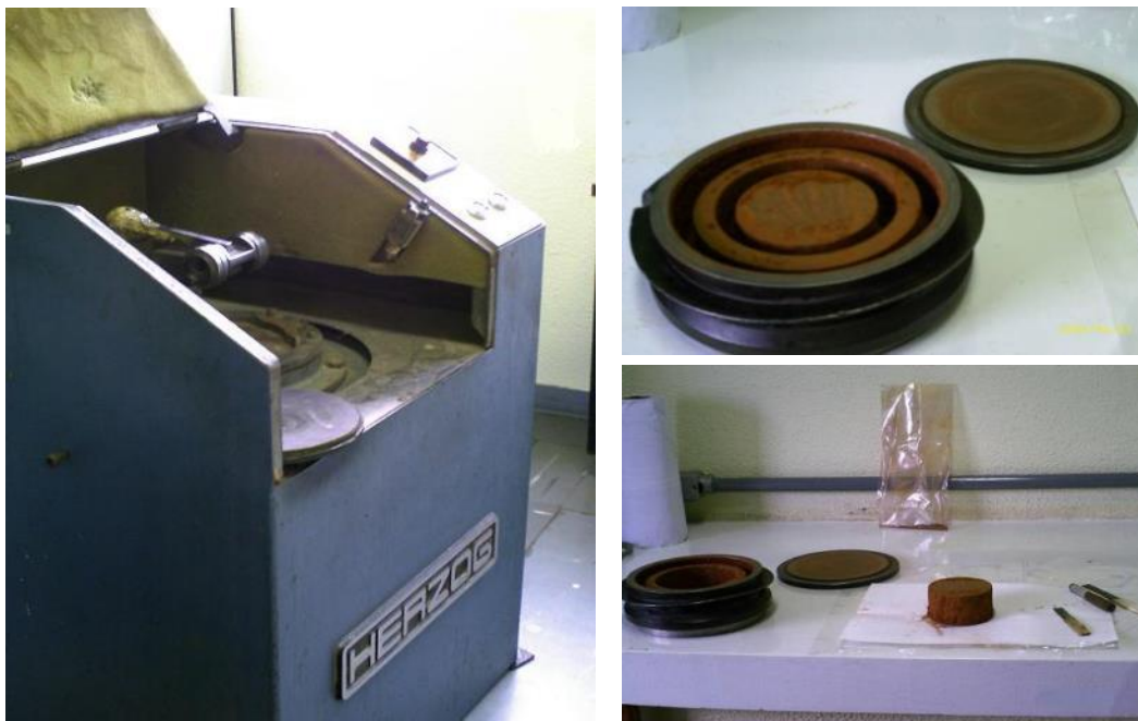
Figura 11 – Equipamento utilizado para pulverização. (Foto: Adriane Nunes Pereira).
