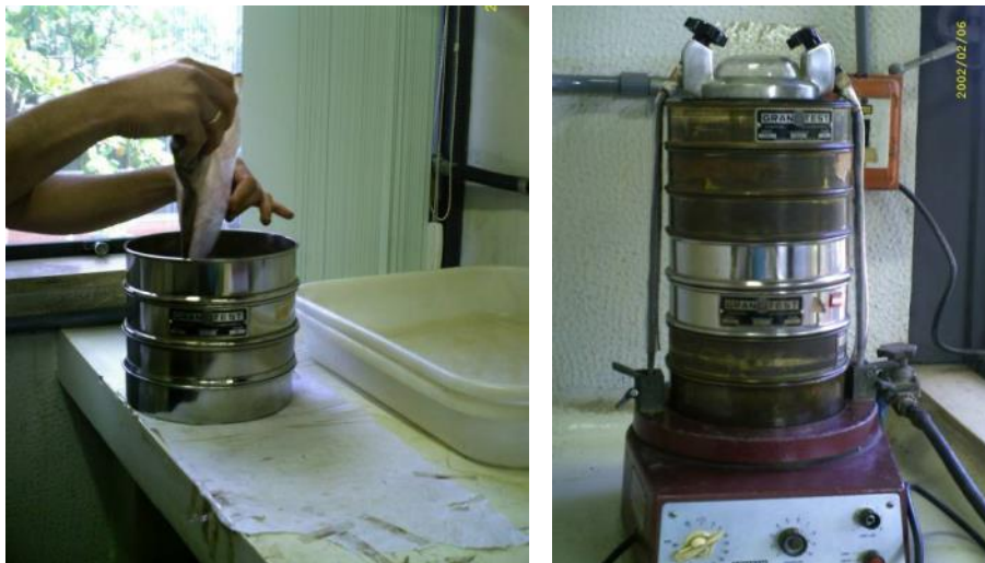
Figura 9 – Processo de peneiramento das amostras (Foto: Adriane Nunes Pereira).
