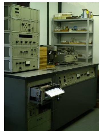
Figura 12 – (a) Material utilizado para confecção das lâminas de vidro orientadas. (b) Equipamento utilizado para difratometria de Raios-X (Foto: Adriane Nunes Pereira)
