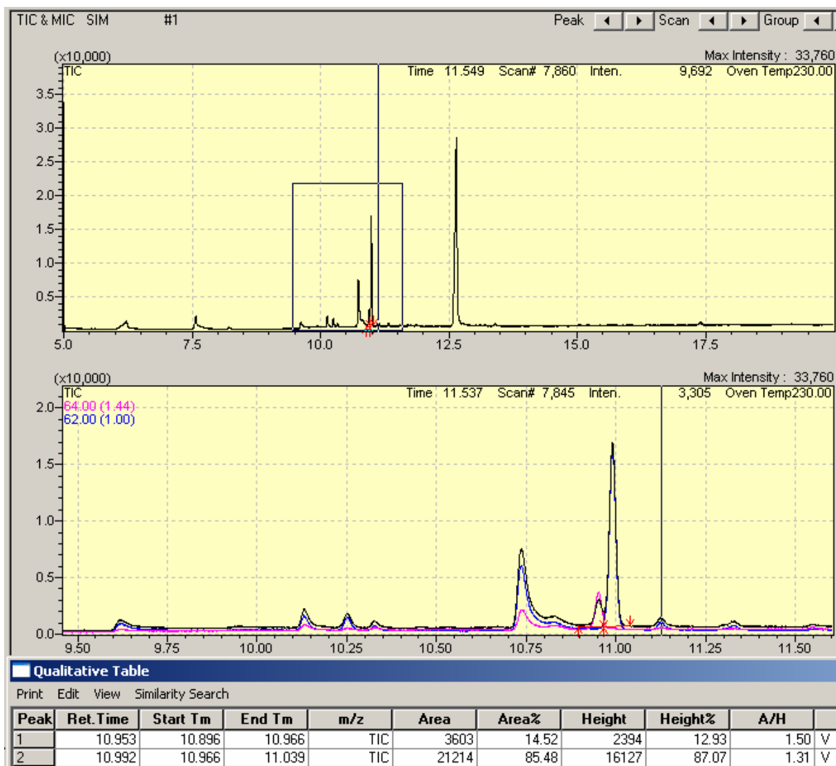
Figura V.4. Cromatograma de carbamato de etila e carbamato de etila deuterado em amostra de aguardente de cana (GC-EM - Injeção manual, temperatura do injetor de 250 °C e temperatura da interface de 230 °C. Programação da temperatura do forno de 90 °C (2 min), elevada a 10 °C/min até 150 °C (0 min), e elevada a 40 °C/min até 230 °C (10 min), coluna HP-FFAP (50 m, 0,25 mm e 0,25 µm); recoberta filme polar de PEG esterificado (0,3 µm espessura). Volume de injeção foi de 1,0 µL no modo splitless com o tempo de abertura da válvula de purga de 60 segundos. Fluxo do gás de arraste, hélio, a 1,5 mL/min; íon monitorado m/z 62).
