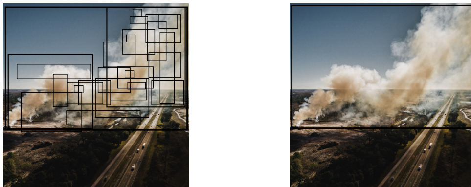
Figura 3.27: Apenas as caixas que o modelo atribuiu uma confiança acima de t_{conf} são mantidas, onde as de maior espessura indicam maior confiança (à esquerda). Como ainda são muitas caixas para um mesmo objeto, a melhor é selecionada através da supressão não-máxima (à direita).
