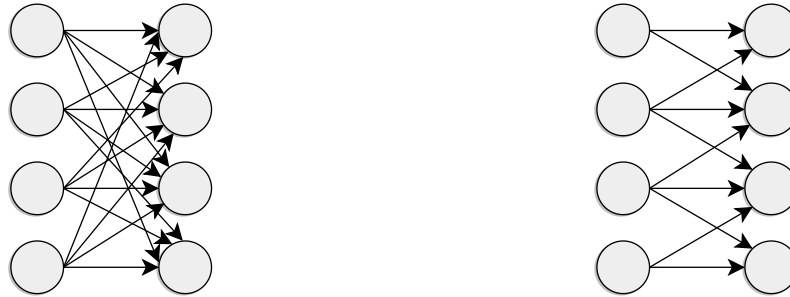
Figura 3.21: A soma ponderada de entrada para um neurônio em uma rede neural totalmente conectada é afetada por todos os neurônios da camada anterior (à esquerda). Já em uma rede neural esparsa, como a rede convolucional, a entrada de um neurônio contém apenas influências de neurônios mais próximos (à direita).
