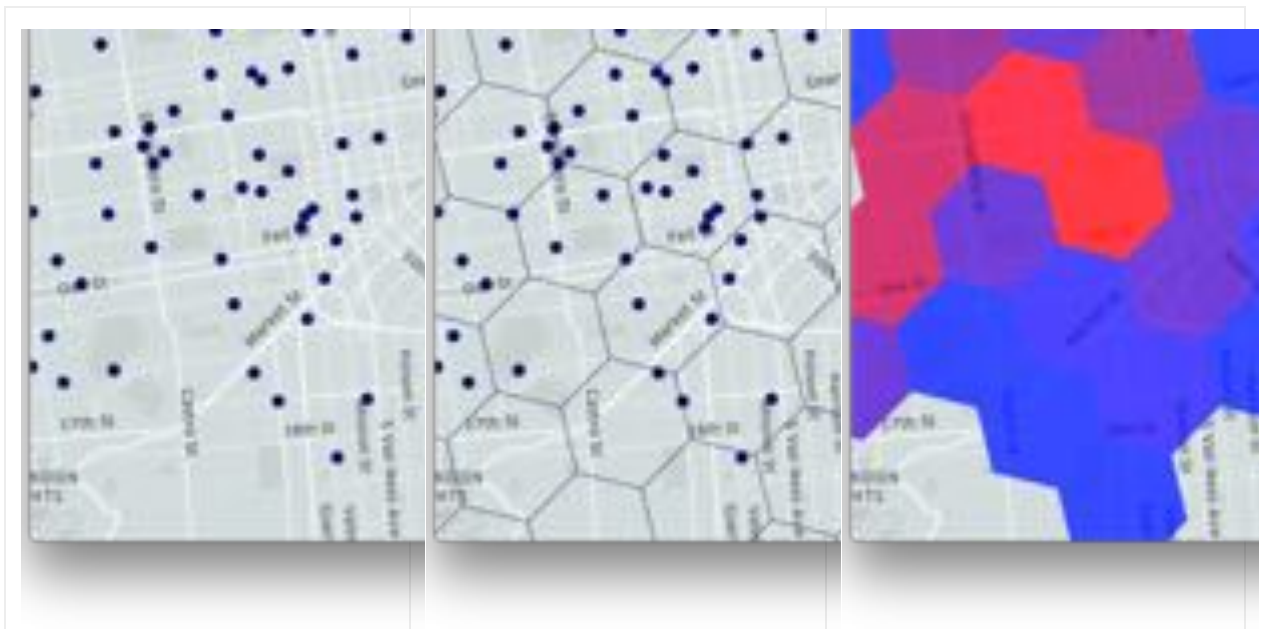
Figura 11 - Figura que ilustra o H3 em ação. Conforme a legenda original: “O mapa retrata o processo de empacotamento de pontos com o H3: carros em uma cidade; carros em hexágonos; hexágonos sombreados de acordo com o número de carros”
