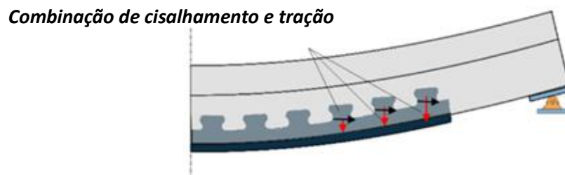
Figura 2.27 – Viga mista com conector Composite Dowel no mecanismo combinado de cisalhamento e flexão (Classen et al. , 2018)
