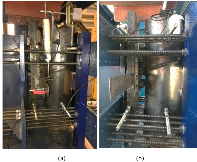
Figura 4.16 – Enrugamento do tubo do modelo E: (a) início; (b) enrugamento do tubo no final do ensaio
