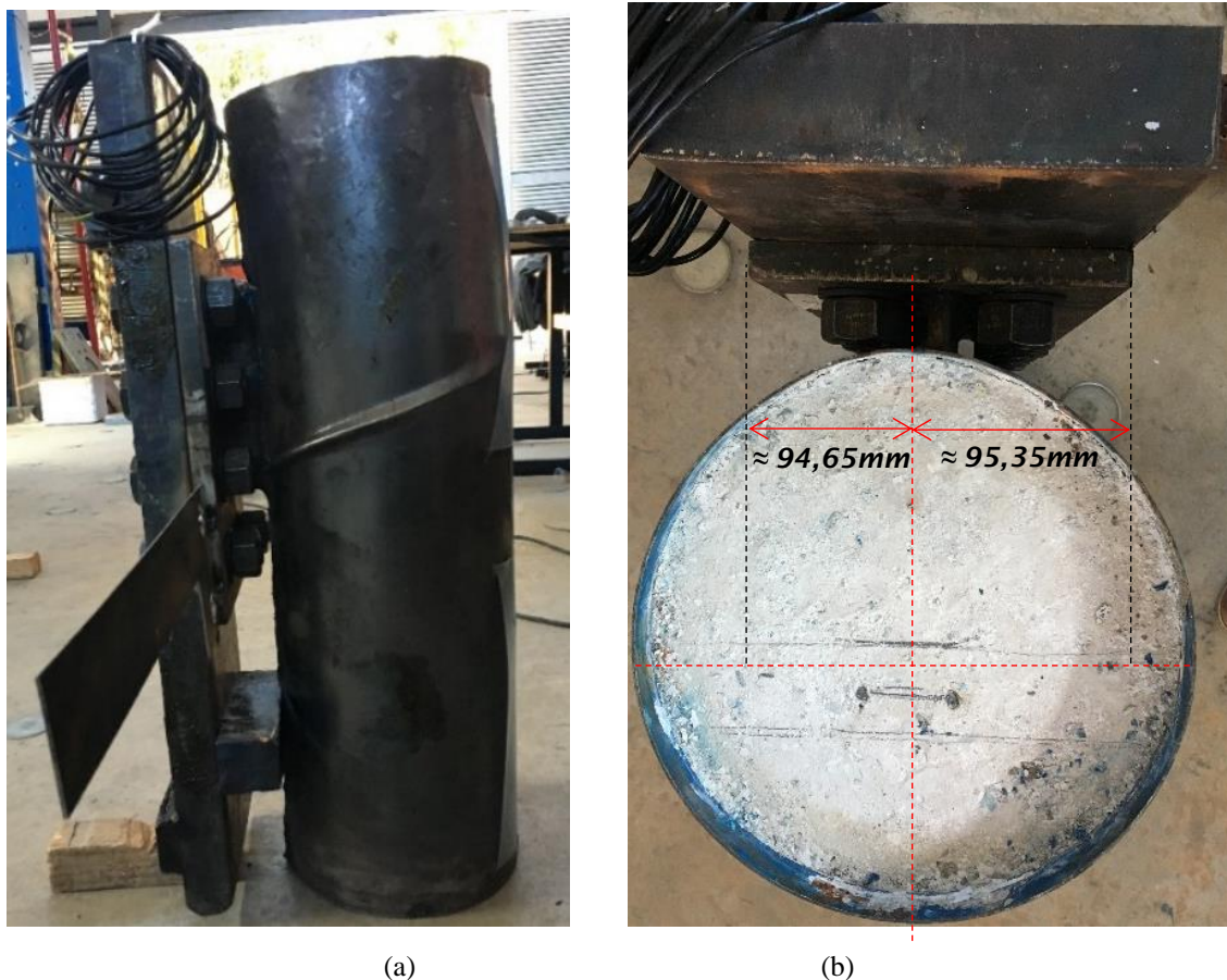
Figura 4.17 – Configuração do modelo E na configuração deformada: (a) Vista lateral; (b) Vista superior.
