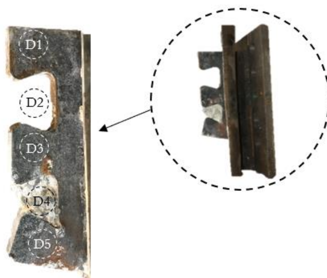
Figura 6.7 – Configuração deformada da chapa do conector: (a) Critério de von Mises no incremento de força máxima; (b) modelo experimental
