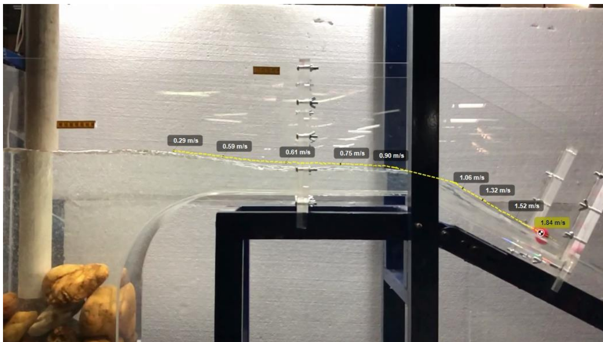
Figura 6.1: Perfil longitudinal de velocidade na entrada do Cenário 1 ( Q=5,2l/s ).
