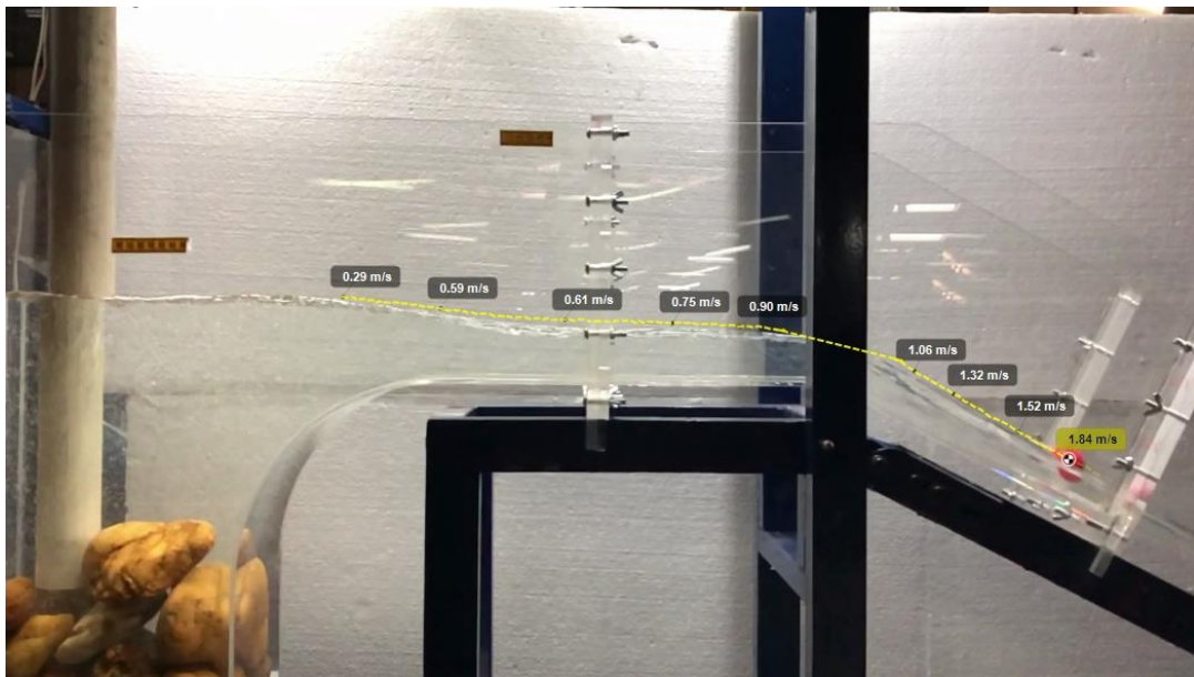
Figura 5.7: Trajetória de velocidades na entrada de uma rampa lisa. Cenário 1, Q_m=5,2 l/s.
