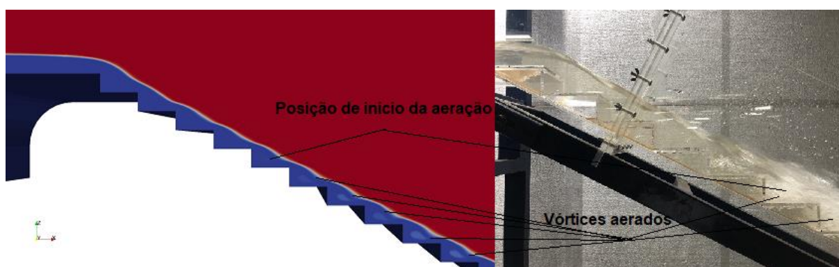
Figura 6.29: Posição de início da aeração – Solver multiphaseEulerFoam .
