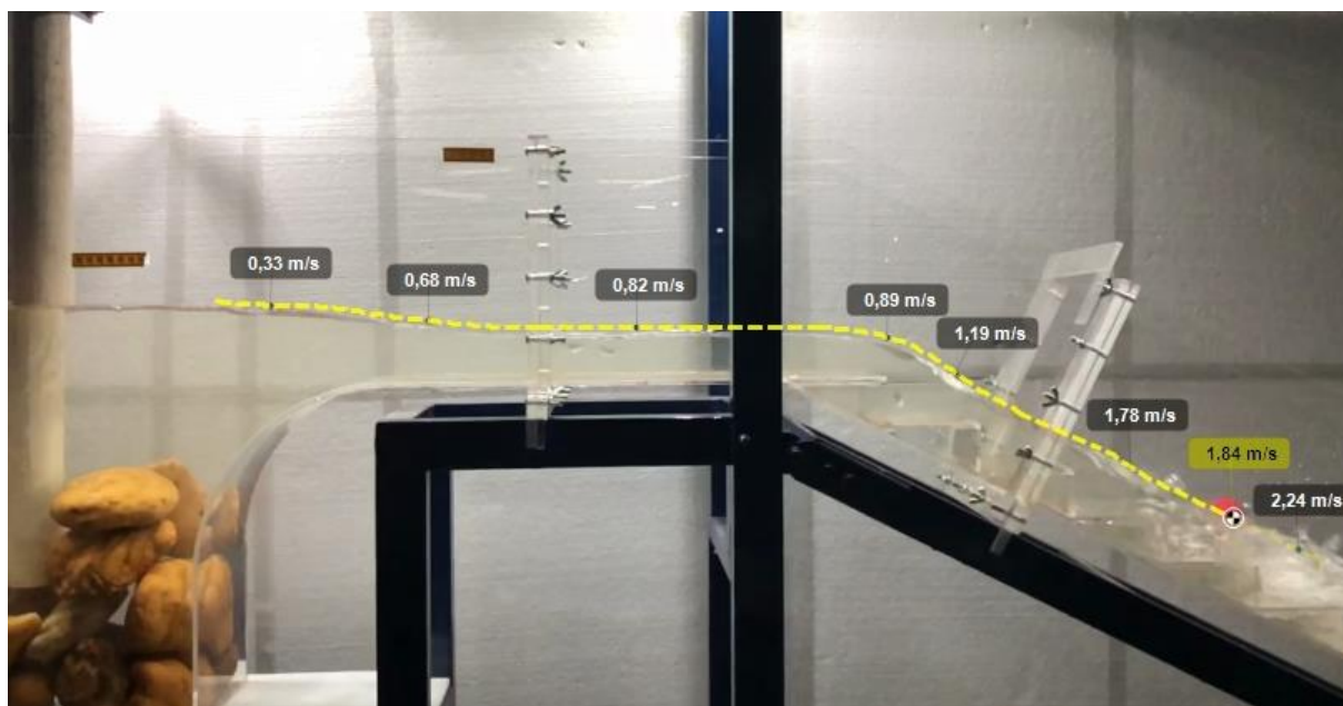
Figura 6.16: Perfil longitudinal de velocidade na entrada do Cenário 2 ( Q=5,2\text{l/s} ).
