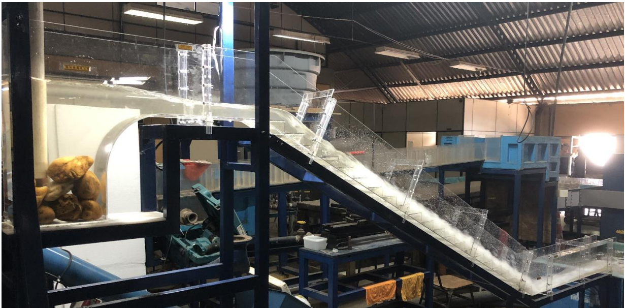
Figura 5.3: Montagem experimental, estrutura com degraus e bacia horizontal.
