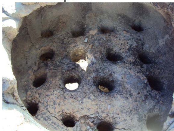
FIGURA 41 - Crivo: suporte c/furos em que as peças são apoiadas e por onde o calor passa, realizando a queima.
