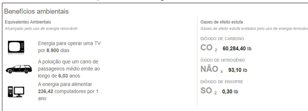
Figura 22 - Benefícios ambientais equivalentes proporcionados pelo uso de energia fotovoltaica gerados na UFV CEA PROPAM e relação com emissão de gases de efeito estufa
