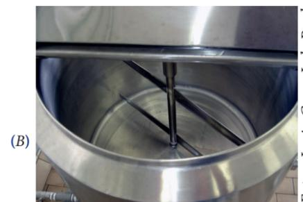
Figura 2 – Equipamentos (a e b) para produção de iogurtes e bebidas lácteas fermentadas. A Figura A mostra a fermenteira com o dosador de bico acoplado. A Figura B mostra o acabamento interno e as pás agitadoras.
