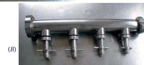
Figura 3 – Equipamentos (A e B) para envase de iogurtes e bebida láctea fermentada.
