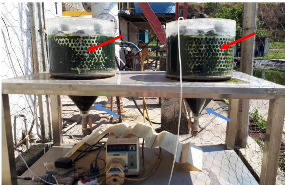
Figura 6.3 – Biorreatores construídos em material transparente evidenciando perfurações no cesto inox destinado a colocação de meio suporte (seta vermelha) e fundo cônico (seta azul)
